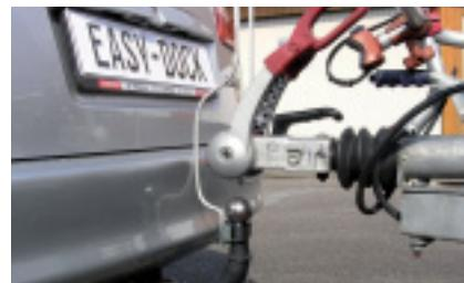
Das System Easy-Dock macht das Ankuppeln laut Herstellerangaben zum Kinderspiel. Dazu hat der Tüftler Peter Gier das herkömmliche Peilverfahren durch eine spezielle Form und Befestigung der Stangen sowie durch eine Zielplatte modifiziert. Es ermöglicht eine einfache Annäherung an den Caravan via Rückspiegel. Das System ist aus hochwertigem Aluminium und Fiberglas gefertigt und lässt sich nach dem Ankuppeln leicht abnehmen und mühelos verstauen.
