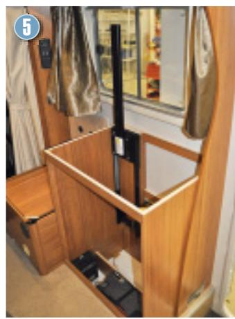
Der Auszug: Ein gefahren reicht bei dem von einem Hubkolben unterstützten Auszug ein kleiner Druck, und der Monitor fährt nach oben.
