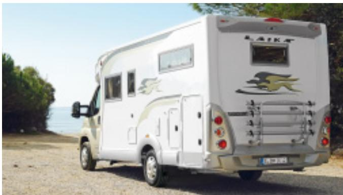
Den Stoßfänger des formschönen Hecks konstruiert der Hersteller reparaturfreundlich. Eine Rückfahrkamera findet unter der dritten Bremsleuchte Platz.
