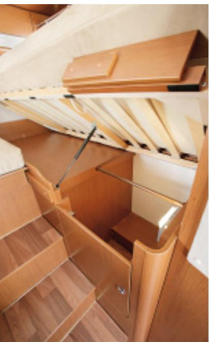
Für einen leichteren Zugriff auf den Kleiderschrank lässt sich der Lattenrost hochklappen. Hierbei hilft ein Gasdruckaufsteller.
