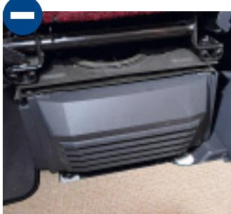
**Am Ende der Bodenplatte entstehen ungeschützte Schmutzlöcher.**
