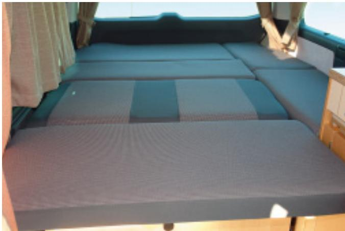
**Trickreich:** Da auf den Einbau eines Längsschranks zu Gunsten einer Stastruhe verzichtet wird, verbreitert sich die Liegefläche des Bettes auf 160 Zentimeter.
