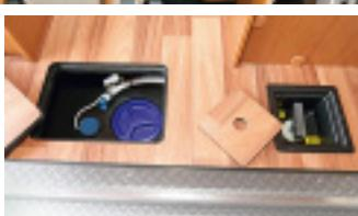
**Links:** Sehr gut erreichbar bringt Hymer die Technik im Doppelboden unter, etwa den Absperrhahn für den Abwassertank.
