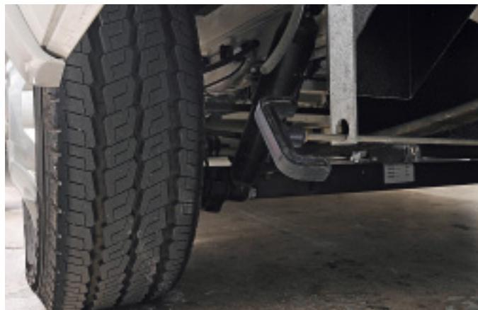
*Der Griff des Ablassschiebers liegt direkt im Spritzbereich des linken Hinterrads.*
