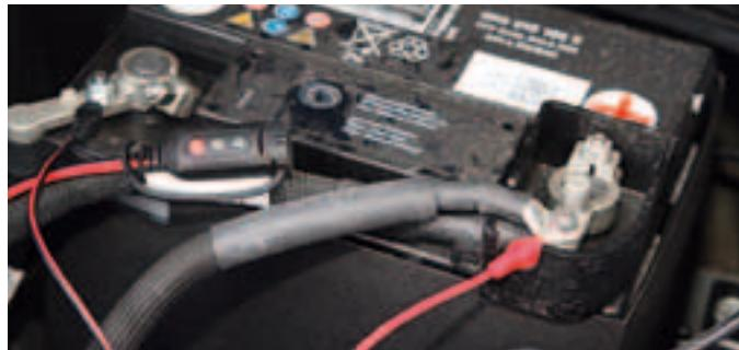
jetzt manuell regelmäßig nachlädt, sichert seiner Batterie eine deutlich höhere Lebensdauer. An der CTEK-Ampel signalisieren drei Leuchtdioden den Zustand der Batterie. Beim Auffüllen von Spritzwasser oder bei der Ölkontrolle erkennt der Fahrer den Ladezustand seiner Batterie und kann rechtzeitig die Batterie ans Ladegerät anschließen – CTEK-Ladegeräte passen
