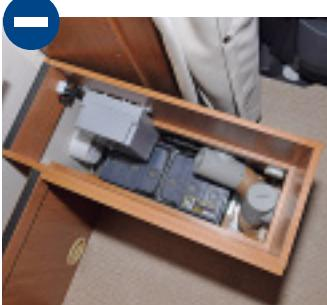
**Die zweite Aufbaubatterie sitzt tief unten im Doppelboden.**
