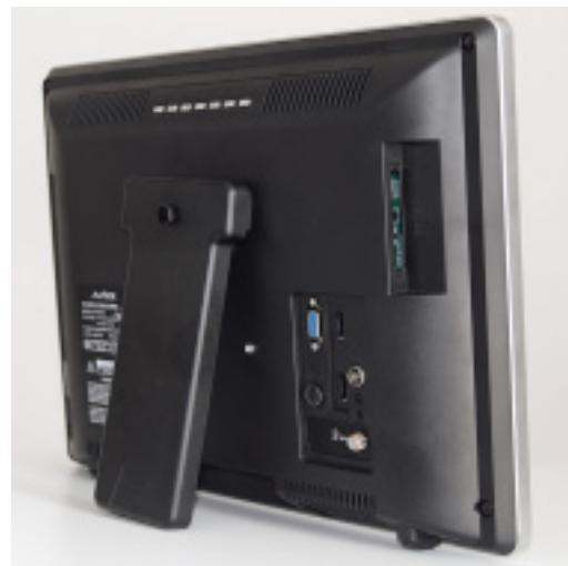
**Die Buchsen bei Avtex zeigen nach hinten. Abgehende Kabel behindern eine wandnahe Montage – in einigen Montagesituationen ungünstig. Hier ein 16-Zoll-Gerät im Bild.**
