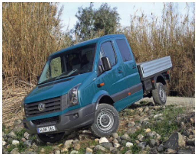
Der Aufpreis durch den nachträglich ausgeführten Umbau gegenüber einem Modell mit Heckantrieb beläuft sich auf knapp 24.000 Euro. Der Crafter 4motion kann ab sofort bestellt werden. Das zulässige Gesamtgewicht reicht beim Crafter 4motion von 3.500 bis 5.000 Kilogramm. Dieses Modell hat dann eine zwillingsbereifte Hinterachse.
