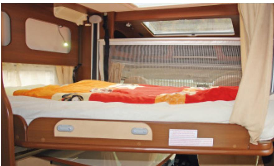
**Dem optionalen Hubbett spendet Laika einen elektrischen Antrieb.** Auch ohne Leiter ist die Liegefläche über den Einzelsitz leicht zu erklimmen. Die Matratze liegt direkt auf der Holzplatte auf. Liegefläche und Wohnraumdecke trennen 73 Zentimeter – ein guter Wert.
