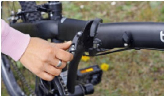
*Das Scharnier am Decathlon muss nach dem Schließen unbedingt manuell gesichert werden.*
