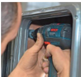
**Step 6:** Mit Bohrkrone einen 29-Millimeter-Durchgang vom Toilettentafel zum Staukasten/Innenraum bohren (hier wird Aktivkohlefilter montiert).
