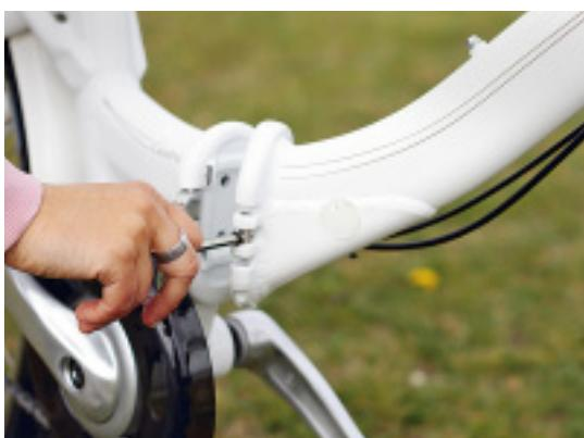
Der Schnellverschluss öffnet leichtgängig und sichert sich beim Schließen automatisch. Sehr gut gelöst.
