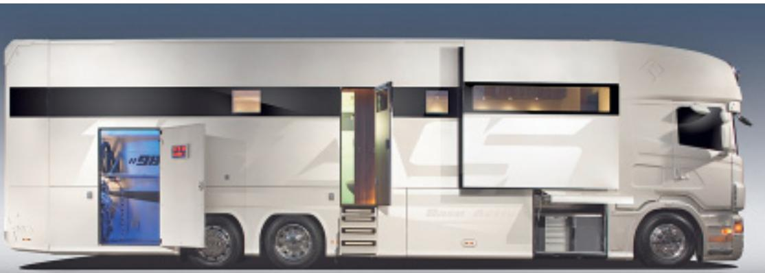
**Das zwölf Meter lange Promi-Mobil von Kettnerer lässt sich dank Slide-Out von 2,50 auf 4,20 Meter Breite vergrößern. In der Höhe wächst es mit Pop-Up auf 4,70 Meter an. Alle Fenster sind mit getöntem Sicherheitsglas ausgestattet.**
