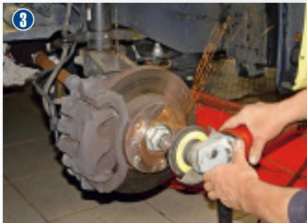
Um einen taumelfreien Rundlauf zu garantieren und zu verhindern, dass sich die Felge verklemmt, schleift ORC-Mitarbeiter Sigi Bosacki die angerostete Felgenauflage der Brems Scheibe blank.
