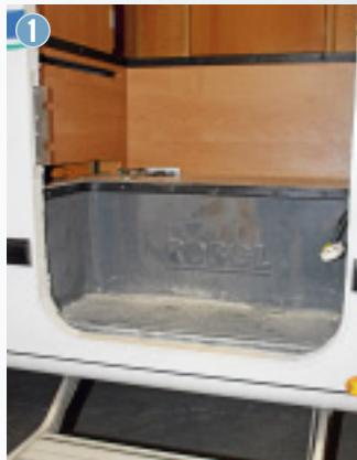
Alte Tür und Rahmen werden sorgfältig entfernt. Bei Bedarf wird der Ausschnitt vergrößert.
