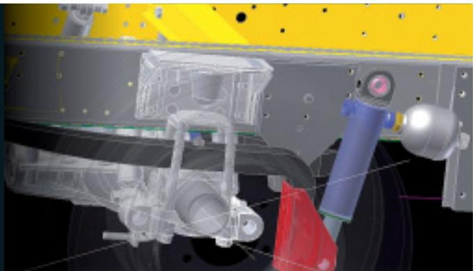
dem eigenen Komfortwunsch und dem Straßenzustand anzupassen und in der Höhe variieren. Zudem reagiert das HP-Fahrwerk binnen Millisekunden und spricht damit wesentlich schneller auf Fahrbahnunebenheiten an.
