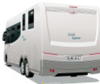
Dach und Wände fertigt LMC aus holzfreiem Alu-Sandwich mit Styrofoam-Isolierung, den Doppelboden aus GFK-Sandwich. Die Preise stehen noch nicht fest.
