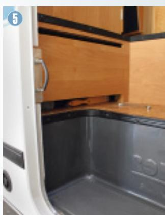
Der Rahmen wird endgültig eingesetzt und mit Aufbau und den Schließbügeln verschraubt.
