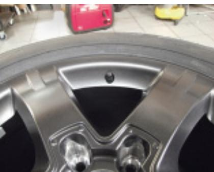
*Die Bohrungen für die passenden Kegelkopfschrauben verdeckt später der Felgendeckel.*
