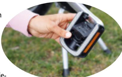
Klapppedale haben beide Fahrräder, sie reduzieren das Packmaß um wertvolle Zentimeter.
