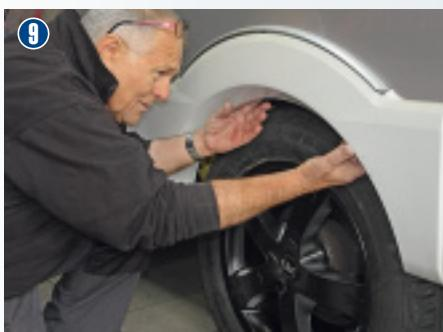
Wolfgang Redweik kontrolliert: Auch bei voll eingefedertem Rad darf der Reifen nirgends schleifen. An der Vorderachse ist dabei zudem die Freigängigkeit im Radkasten bei vollem Lenkeinschlag zu kontrollieren.
