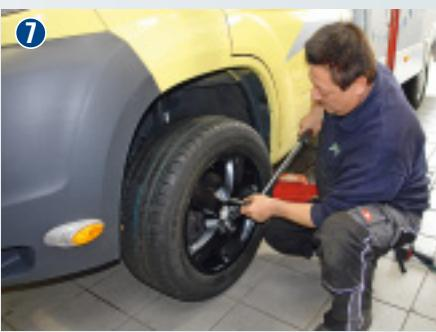
Passendes Drehmoment sichert und schont die Alufelge perfekt. Bei der ORC-Felge liegt dieser Wert bei 160 Newtonmetern (Nm).
