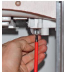
**Step 3:** Thetford-Schieberknaufführung deinstallieren. Ihn muss der Monteur bei der C200 etwas kürzen (nicht beim Folgemodell 250). Entlang der roten Linie absägen und wieder montieren.
