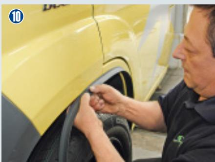
Weil die vorderen Kotflügel die neuen Räder nicht komplett überdecken, montiert der Mitarbeiter von ORC selbstklebende Gummilippen, die er im Bereich des Kunststoffstoßfängers zusätzlich verschraubt.
