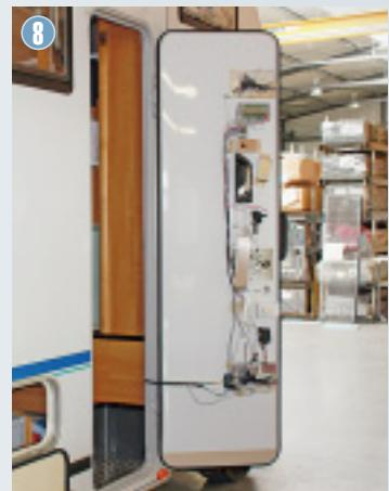
Die komplexe Verriegelung wird verkabelt und justiert. Die passende Innenabdeckung mit Taschen wird montiert.
