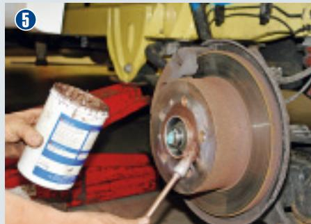
Eine hauchdünne Schicht Aluminiumpaste verhindert erneute Korrosion. So lässt sich das Rad beim herbstlichen Räderwechsel leichter wieder abnehmen.
