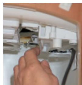
**Step 5:** Kleiner Funktionscheck: Im linken Bild der Öffnungsriegel in seiner Ausgangsposition mit offenem Microschalter. Rechts: Die eingeschobene Kassette schließt den Öffnungsriegel und dieser den Microschalter – die Absaugung würde jetzt anlaufen.
