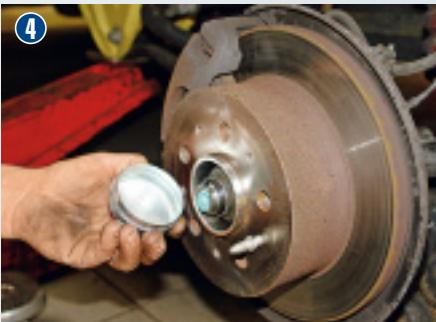
Der zu hohe Nabendeckel an der Hinterachse muss entfernt werden. Die Alufelge schützt das gekapselte Radlager vor Feuchtigkeit, der Monteur versiegelt es zudem mit reichlich Fett.
