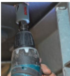
**Step 7:** Mit Bohrkrone 29-Millimeter-Durchgang vom Staukasten durch den Fahrzeugboden bohren.
