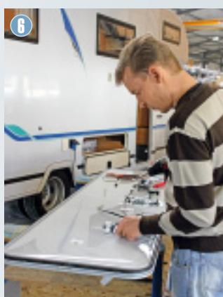
Die komplexe Verschlussmimik mit Zuziehmechanismus wird ins Türblatt passgenau eingesetzt.
