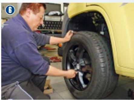
Das neue Alurad montiert der Mechaniker mit dazu passenden, längeren Radschrauben. Die originalen kommen weiterhin bei den Stahlfelgen zum Einsatz.
