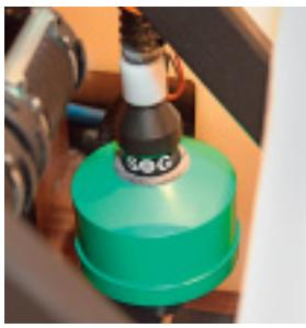
**Step 9:** Im Staukasten Aktivkohlefilter auf Bodendurchlass fixieren, Lüftermotor aufstecken, Schlauch und Kabel durch Wandbohrung ins Toilettentafel führen.
