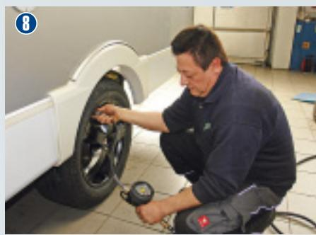
Der richtige Luftdruck entscheidet über Lebensdauer, Grip, Seitenführung, Rollwiderstand und Abrollkomfort eines Reifens.
