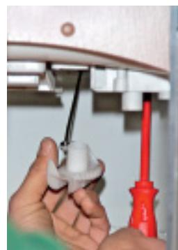
**Step 2:** Bevor rechts die Schieberknaufführung deinstalliert werden kann, muss der Öffnungsriegel raus.
