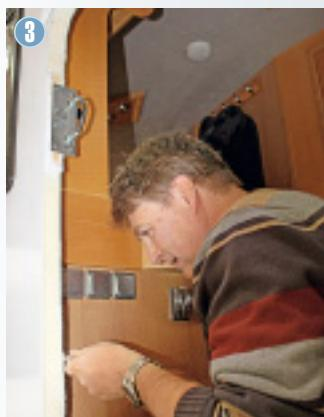
Die Halterriegel werden in der Seitenwand verschraubt, diese können starr oder flexibel sein.
