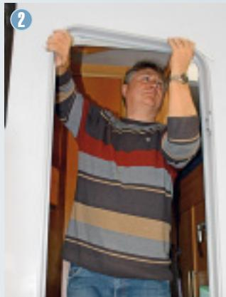
Der neue Außenrahmen wird erstmals angepasst, damit die Verriegelung platziert werden kann.
