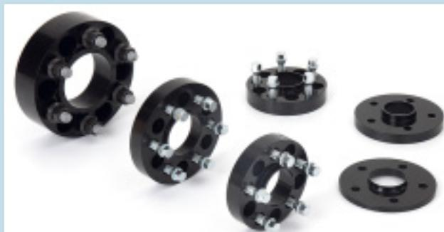
Die breitere Spur hat einen weiteren positiven Nebeneffekt: Durch den breiteren Hebelarm spricht die Federung etwas sensibler an, der Fahrkomfort steigt. Und ganz nebenbei: Das Fahrzeug sieht mit breiter Spur einfach besser aus.
