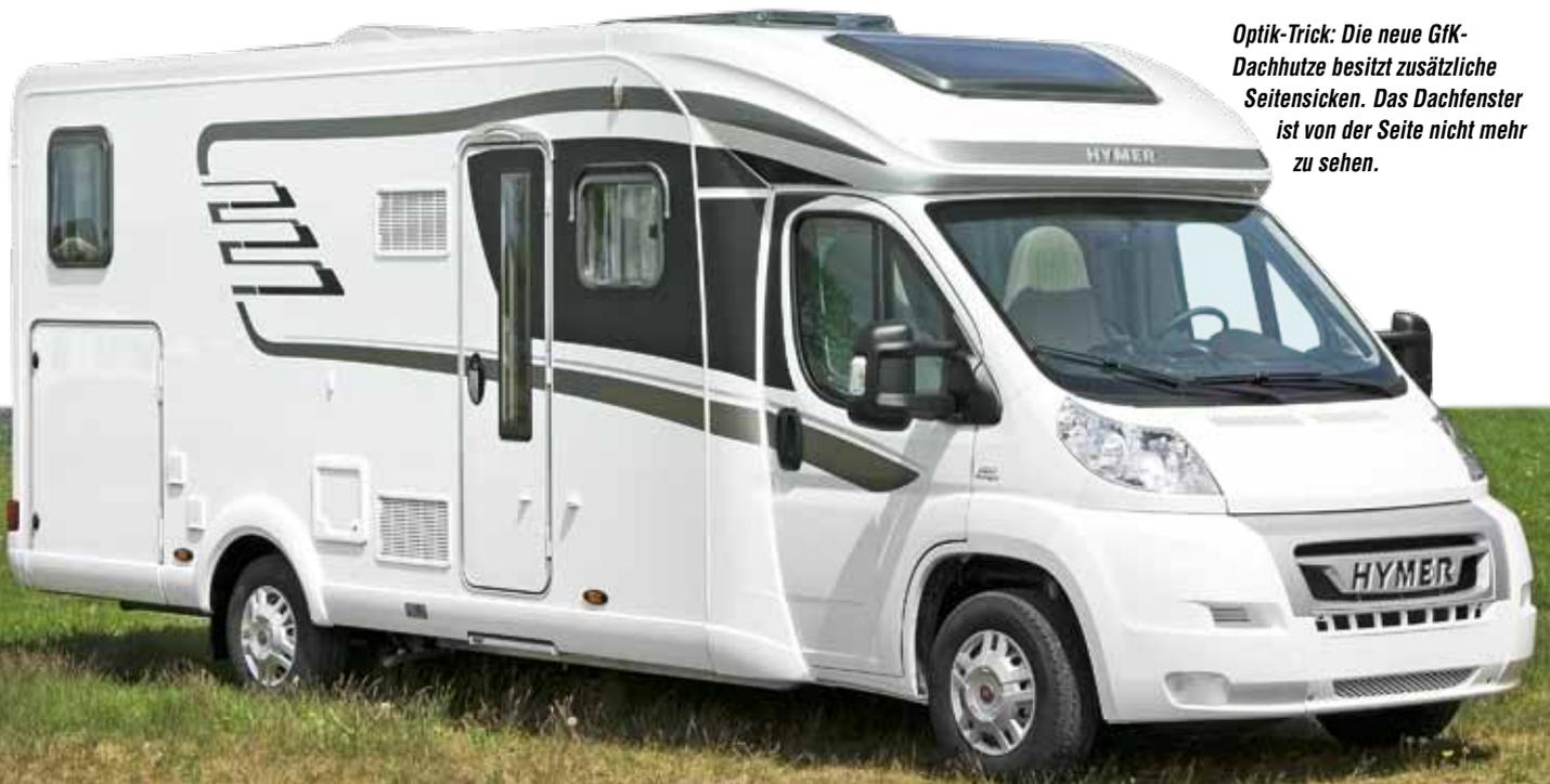
*Optik-Trick: Die neue G1K-Dachhülle besitzt zusätzliche Seitensicken. Das Dachfenster ist von der Seite nicht mehr zu sehen.*
