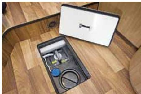
*Über eine Serviceklappe hat der Hymer-Eigner Zugriff auf die unterflur montierten Versorgungstanks.*
