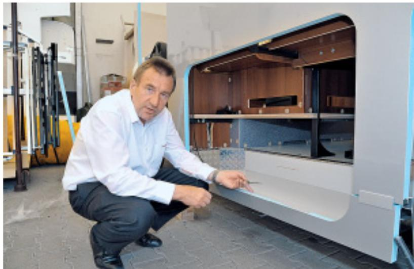
**Karl-Heinz Schuler zeigt am Prototypen das neue Doppelbodenkonzept. 225 Millimeter trennen Unterboden und Fußboden. Die Sandwichplatten für den Aufbau fertigt Carthago selbst und verwendet hierfür Aluminium und GfK sowie RTM-Schaum als Isolierung.**
