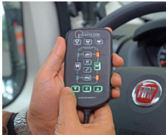
*Handarbeit: Mit dem Intelligente-Bedienteil lässt sich die Luftfederung bei Bedarf individuell steuern. Standardmäßig arbeitet sie im Automatik-Modus.*
