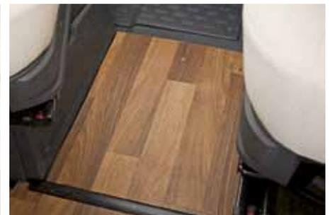
*Den Durchgang ins Cockpit legt Hymer mit PVC-Bodenbelag aus. Ganz wie in einem Integrierten.*
