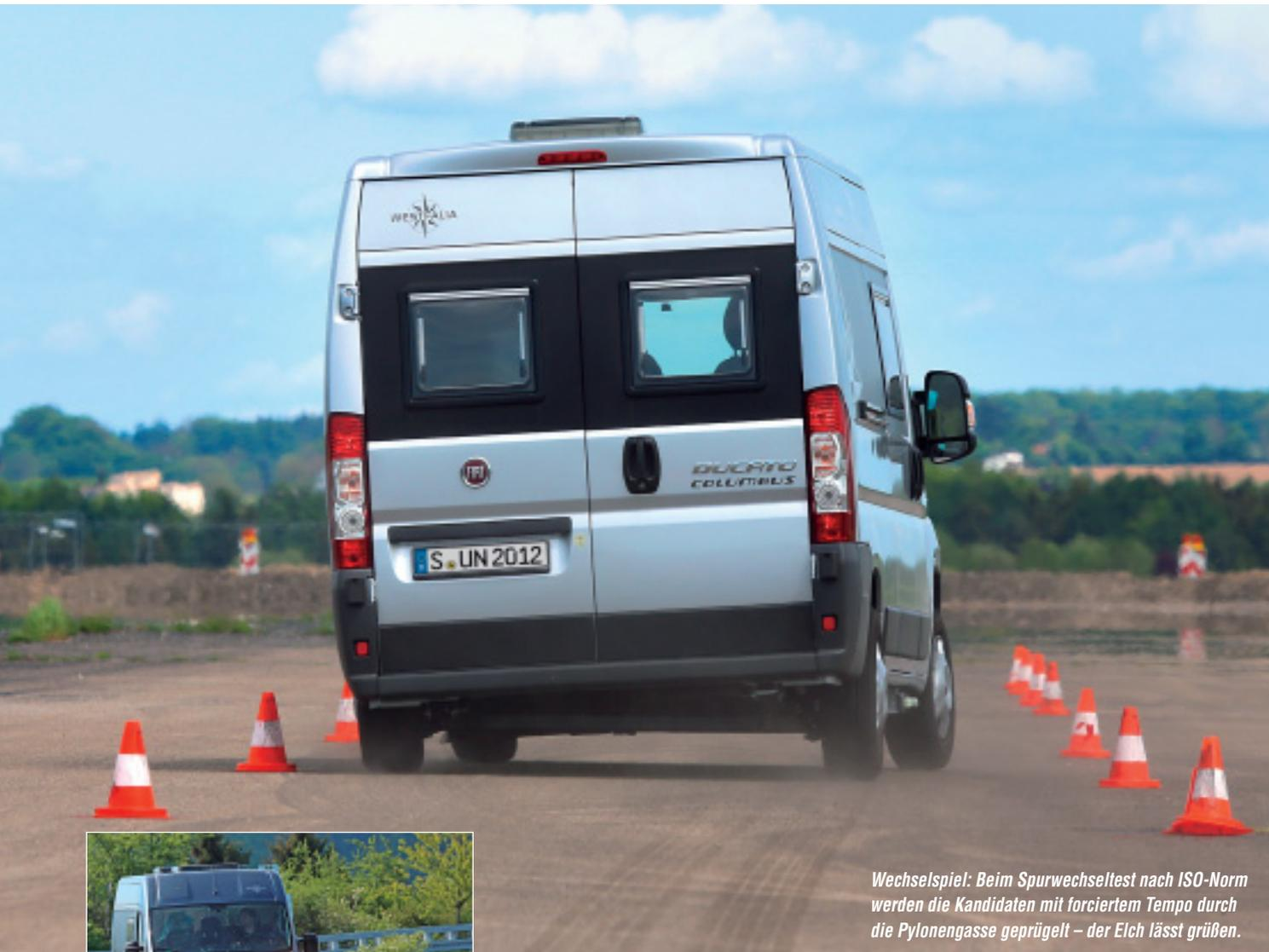
*Wechselspiel: Beim Spurwechseltest nach ISO-Norm werden die Kandidaten mit forciertem Tempo durch die Pylonengasse geprügelt – der Elch lässt grüßen.*
