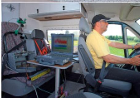
*Holterdiepolter: Mit Schmackes geht es übers Kopfsteinpflaster im Belgisch-Block-Zuschnitt. Der Profitest-Dummy (links) registriert akribisch die Komfortwerte.*
