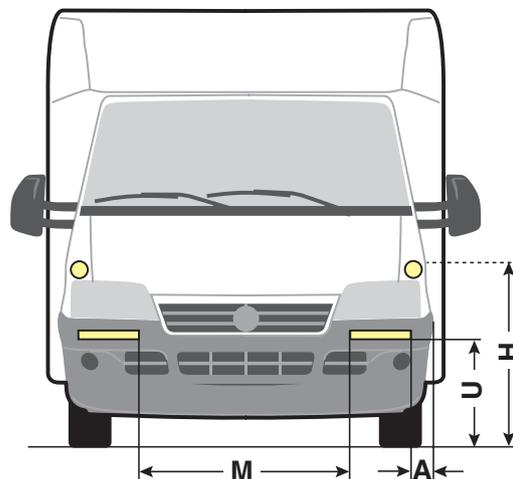
*Diese Maße gilt es zu beachten:  $M$  ist der Abstand zwischen beiden Leuchten,  $A$  der Abstand zum äußeren Fahrzeugumriss,  $U$  ist die untere Anbauhöhe und  $H$  die maximale Anbauhöhe.*
