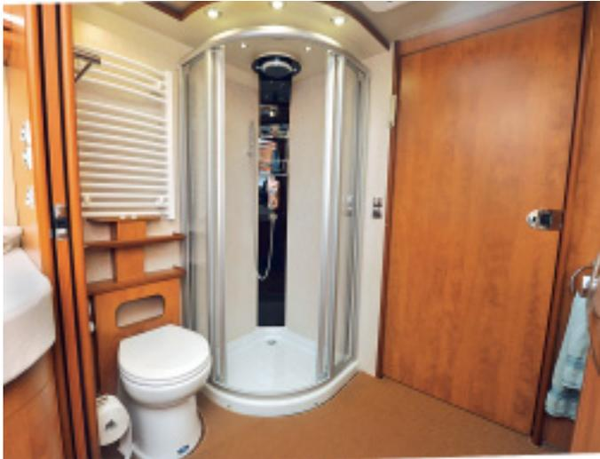
In der großen Dusche montiert der Hersteller einen Regenwasser-Duschkopf mit drei Einzel-LEDs. Er verringert die Stehhöhe von 191 auf 185 Zentimeter.
