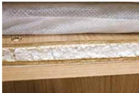
*Um Gewicht zu sparen, fertigt Hymer die Möbelplatten in Sandwichbauweise mit Styroporfüllung.*
