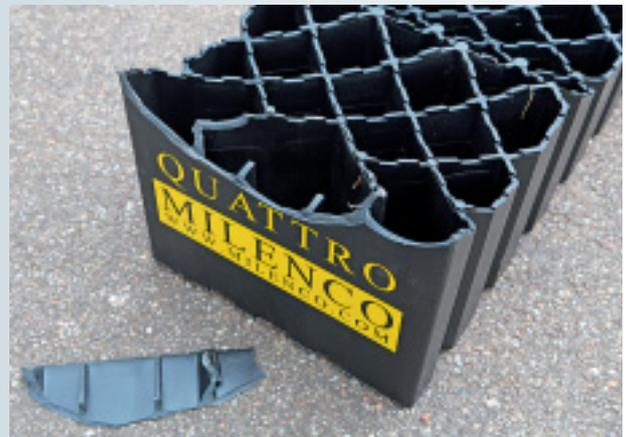
*Werden die Stackers auf groben Kies gelegt, kann sich der Kunststoff unter der Last des Reisemobils stark deformieren. Dann lassen sich die Teile nur noch schwer oder gar nicht mehr zusammenstecken.*
