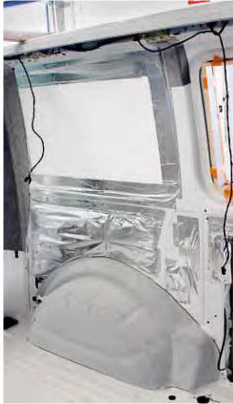
Links: Hinter der Dampfsperre versteckt sich die dicke Isolierung. Feuchtigkeit hat hier keine Chance durchzudringen.
