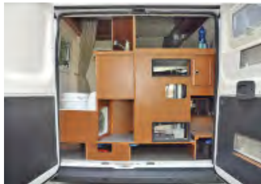
Über die Duca-to-Hecktüren lassen sich die hinteren Bodenstauflächen beladen. Zudem finden sich hier Teile der Bordtechnik wie etwa der Abwasserhahn.
