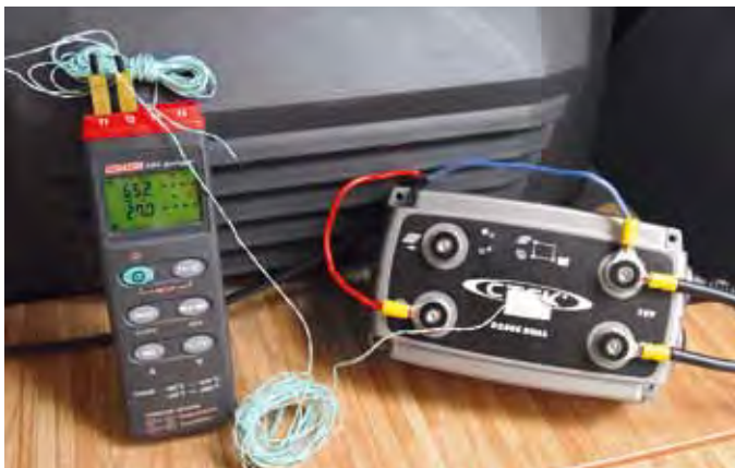
Bei einer Umgebungstemperatur von 27 Grad erhitzt sich das CTEK auf 65 Grad, obwohl durch die Tür immer etwas kühlende Frischluft strömt. Unter einem Karton, also nur leicht abgeschottet, steigt die Temperatur sofort auf 73 Grad.
