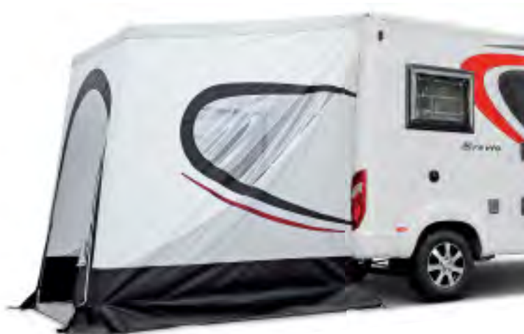
Die große Heckklappe aus Glasfaser verstärktem Kunststoff stützt das Dach des auf Sonderwunsch lieferbaren Heckzeltes.
