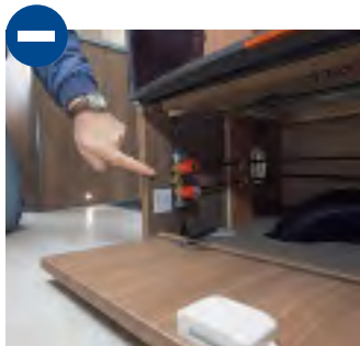
Die Gasabsperrhähne sitzen sehr tief, so dass man auf die Knie gehen muss.
