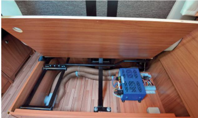
**Gelungene Lösungen:** Die Elektrozentrale ist in der Sitzbank gut erreichbar. Heizung und Ablasshahn für den Boiler haben ihren Platz unter dem Kleiderschrank, die Gasabsperrhähne sitzen im Küchenunterschrank (unten).
