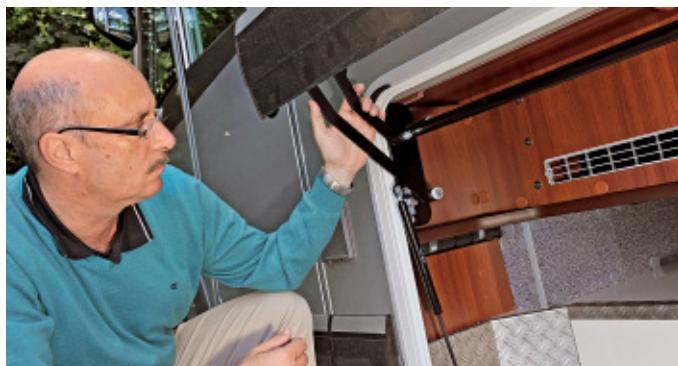
Dank eines Scherenmechanismus gleitet die große Klappe parallel zur Außenwand nach oben. Die Heckgarage ist an sich riesig, der Bettaufstieg im Innern schränkt sie ein wenig ein.
