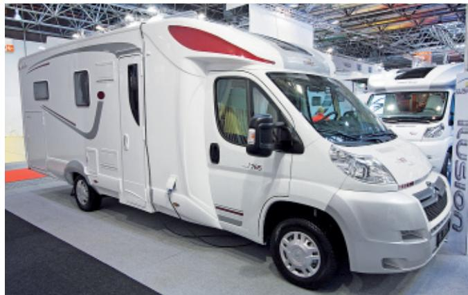
**Markant:** Das GfK-Dach der Illusion-Teilintegrierten wölbt sich elegant einem Winkel von vier Grad.
