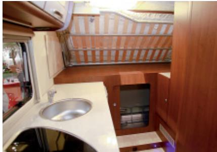
*Praktisch: Der Lattenrost des Heckbetts ist aufstellbar. So gelangt man von innen leichter an den Laderaum der Heckgarage.*
