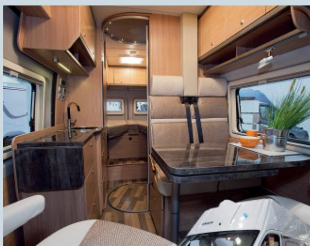
**Einfallsreich:** Um Platz zu sparen, baut Knaus die Duschtasse in den Mittelgang ein und deckt sie mit einer Holzplatte ab.
