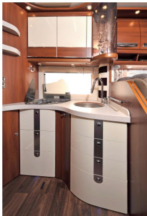
**Zwei Müllsammler sind unten in den Apothekerauszug eingelassen. Die Gasabsperrhähne platziert Carthago griffigünstig dahinter. Im Doppelboden sitzt der überwiegende Teil der Installation. Eine isolierte Wanne erweitert das Stauvolumen.**
