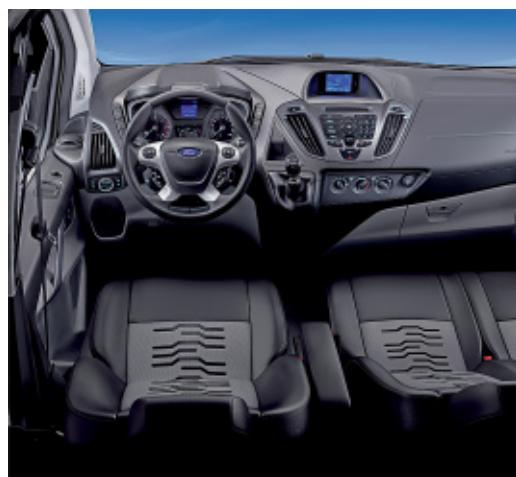
*Optimiert: Die Sitze sind jetzt bequemer und höhenverstellbar. Die Lenksäule lässt sich in der Höhe und in der Längsachse verstellen. Das verbessert den Fahrkomfort.*
