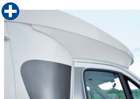
Die Übergänge zwischen Hutze, Fahrerhaus und Wohnaufbau sind sorgfältig verfugt.
