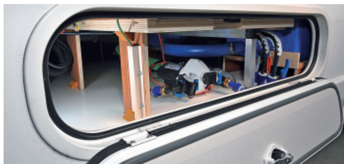
Der Doppelboden ist frei für die Technik-Installation. Hier liegen auch die Ablasschieber und die Entleerungsventile der Wasserleitungen.
