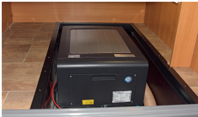
Perfekte Einbausituation: Im beheizten Zwischenboden findet die Truma Vega ausreichend Platz und lässt sich leicht einbauen.
