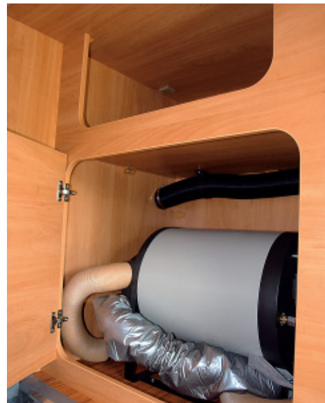
Ideal für zwei: Die breiten Einzelbetten bieten guten Liegekomfort. Leicht erreichbar installiert Dethleffs die Truma-Heizung in einem der Kleider- und Wäscheschränke unter den Heckbetten.
