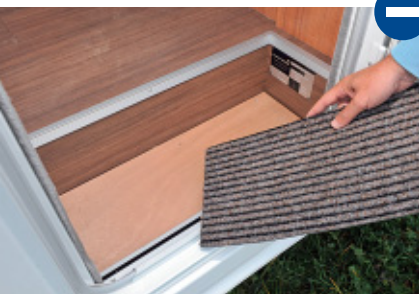
Ungenau eingepasst, ist das Brett unter dem Teppich ein Schmutzfänger.
