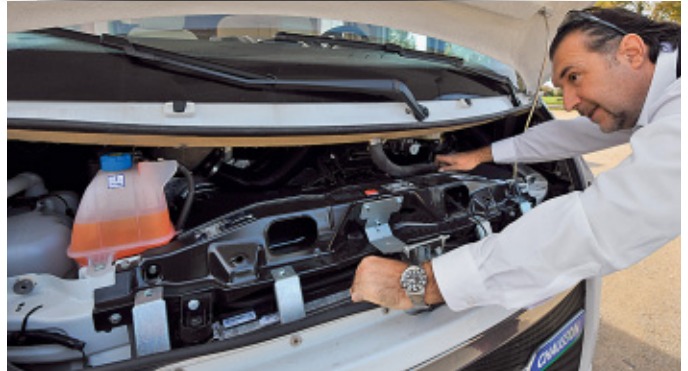
Servicefreundlich: Die Betriebsstofftanks lassen sich leicht befüllen.
