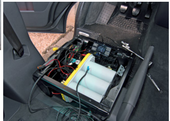
Vier Schrauben arretieren den Fahrersitz im T5. Beim Ausbau aufgepasst: Der Airbag-Stecker muss fachmännisch gelöst werden. Unter dem Sitz findet sich ausreichend Platz für die 75-Ah-Optima.
