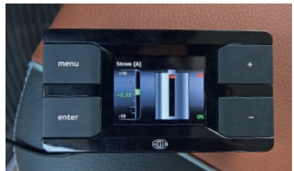
Der Hella-Computer gibt verlässlich Auskunft über Ladestrom und die Batteriespannung – und erinnert bei geringem Ladestrom daran, das Panel mal wieder zu entstauben.
