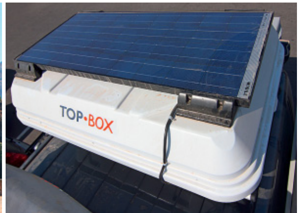
Edelstahlschrauben mit großen Gegenplatten sichern das Büttner-Solarmodul auf der Thule-Topbox. Öffnen und Schließen gelingt mit dem Extragewicht völlig problemlos.
