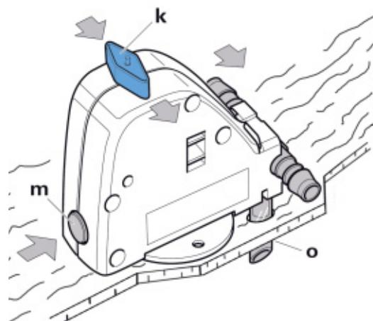
**Grundsätzlich neigt das unterflur liegende Ablaurohr (o) nicht zum Verschmutzen. Sitzt der Stutzen aber nahe an einem Reifen, wirbelt dieser womöglich Schmutz, Laub oder Schneematsch in die Öffnung.**
