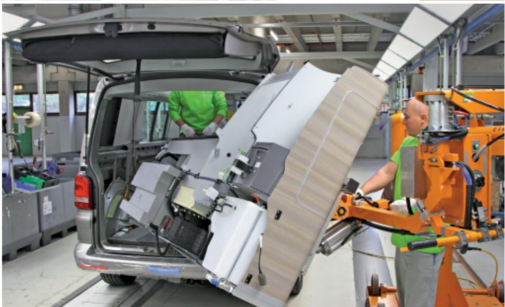
Bevor die Küche am Roboter-Arm ins Fahrzeug gelangt, wird sie bei VW endmontiert und auf die korrekte Funktion überprüft.
