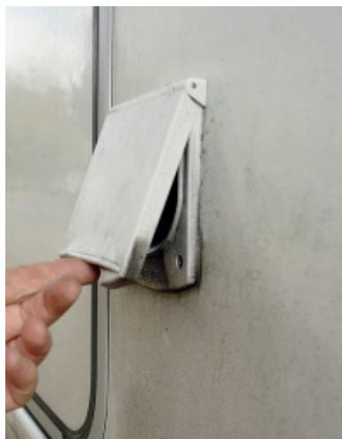
**Der Tankdeckel schloss gegen Testende nicht mehr richtig. Den Stutzen sichert aber zusätzlich ein abschließbarer Deckel.**
