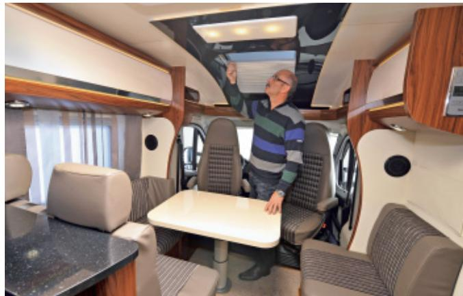
Das Fenster in der Hutze ist starr, kann nicht geöffnet werden. Schick: Ein dunkler Baldachin und Lichtbänder rahmen es ein.
