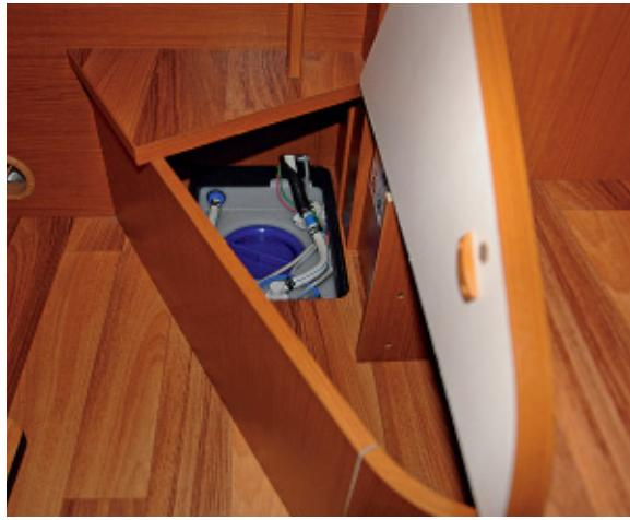
**Die Stufen zum Bett konstruiert Hymer als praktische Staufächer mit Deckel. In der unteren Stufe findet sich, verdeckt unter einem weiteren Deckelchen, der Frischwassertank mit Ablassventil.**
