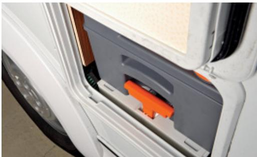
Der Spalt zwischen Toiletten-Kassette und Tür ist ringsum offen. Überlaufende Flüssigkeit verschwindet im Mobil.
