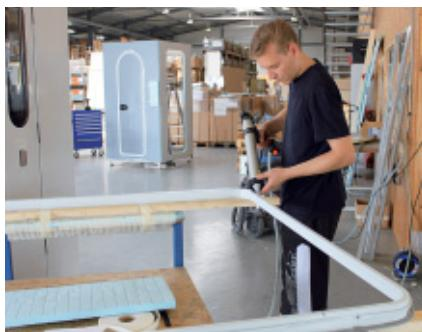
Der neue Rahmen entsteht aus dem passenden Aluminiumprofil entsprechend der Karosserieöffnung. Vassily Ussenko trägt die Karosseriedichtmasse auf.
