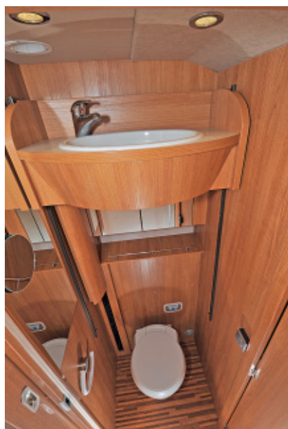
Variable Raumgestaltung: Aus Längsbad und Dusche wird ein großes Raumbad. Dazu rasten eine Schiebetür und die Badezimmertür gegenüber auf der anderen Seite des Mittelgangs ein.
