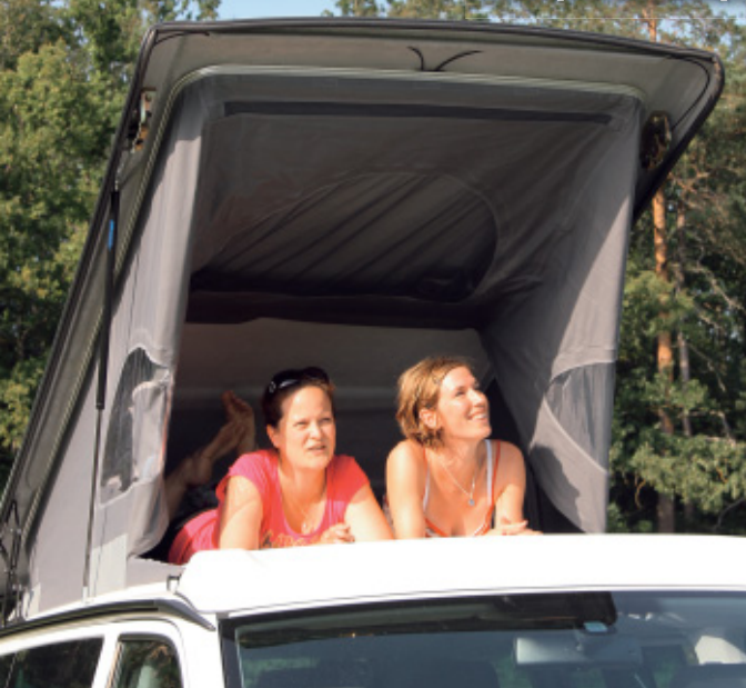
Spacecamper bieten ein sehr luftiges Zelt. Schlafen unter freiem Himmel ist möglich. Gasdruckdämpfer halten das Dach oben.
