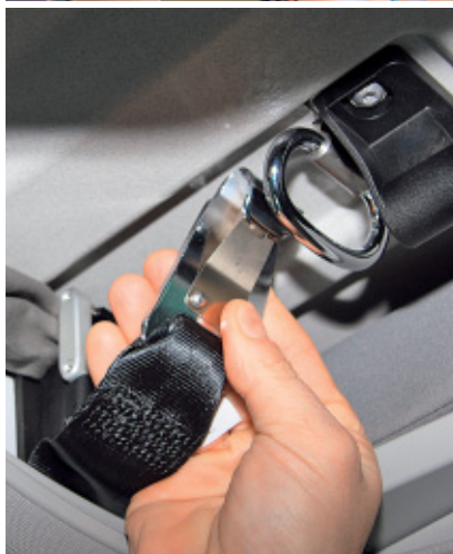
Rechts: Es gibt viele Dachverschlüsse. Dieser hier ist aus dem VW Beach. Der Schnappverschluss wird mit einem Riemen gesichert.
