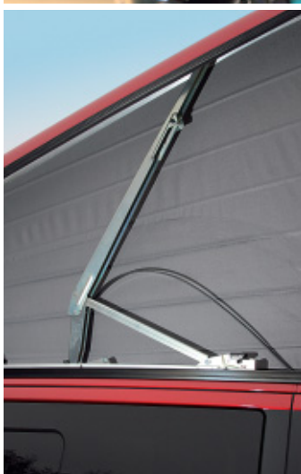
Oben links: Die Scheren führen das Dach und halten es seitlich.
