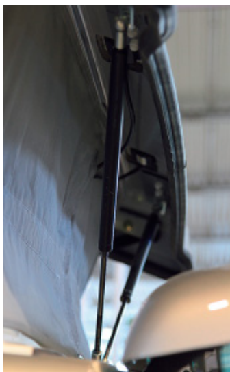
Spacecamper bieten ein sehr luftiges Zelt. Schlafen unter freiem Himmel ist möglich. Gasdruckdämpfer halten das Dach oben.
