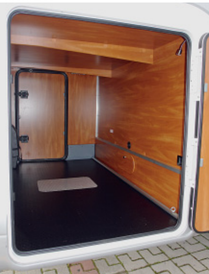
Die geräumige Heckgarage sollten Camper wegen des langen Hecküberhangs nicht zu schwer beladen.
