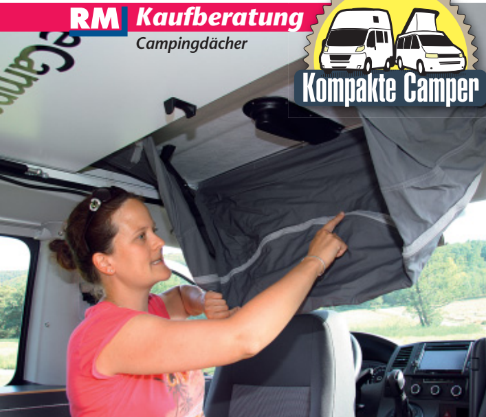
Vor dem Aufstellen wird der Balg freigelegt. Hier ist ein Zentralschloss zu sehen. Es greift auf die seitlichen Dachverschlüsse.
