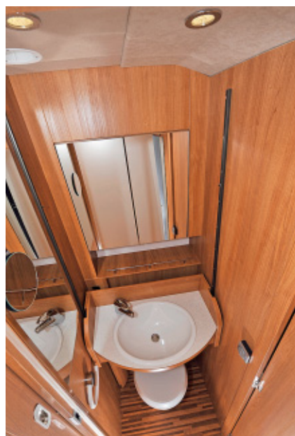
Variable Raumgestaltung: Aus Längsbad und Dusche wird ein großes Raumbad. Dazu rasten eine Schiebetür und die Badezimmertür gegenüber auf der anderen Seite des Mittelgangs ein.
