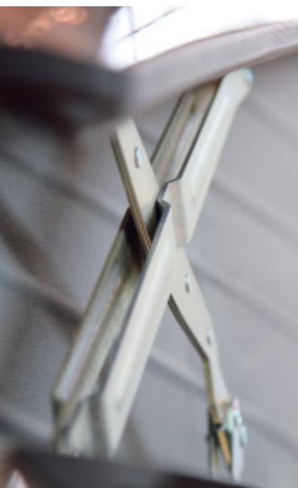
Oben links: Die Scheren führen das Dach und halten es seitlich.
