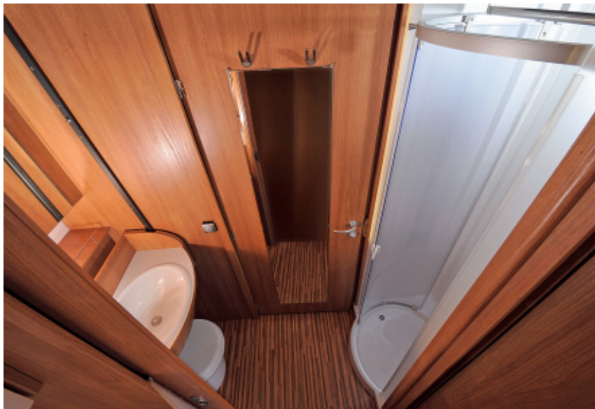
Variable Raumgestaltung: Aus Längsbad und Dusche wird ein großes Raumbad. Dazu rasten eine Schiebetür und die Badezimmertür gegenüber auf der anderen Seite des Mittelgangs ein.
