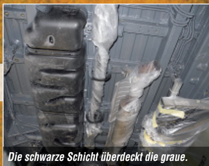
Fett schützt Schweißnähte und Falze.
