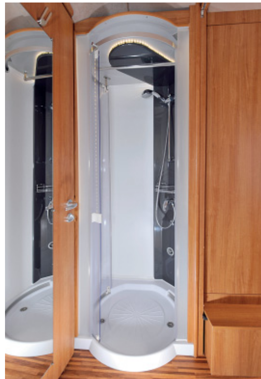
Einfallsreich: Um Platz zu sparen, befestigt Frankia den Waschtisch an zwei Wandschienen. So lässt er sich hoch- und runterfahren (links). Die geräumige Runddusche hat zwei Wasserabläufe.
