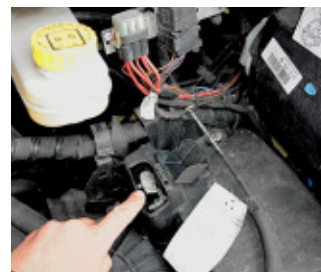
Den Anschluss für den Pluspol der Batterie sollte Fiat rot markieren.
