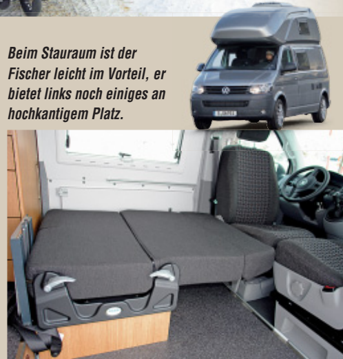
Das untere Fischer-Bett wird etwas aufwendig aus der Rücksitzbank und dem Fahrersitz gebaut.
