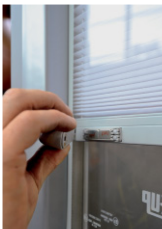
Das Rollo der Hecktür verschmutzt und verknittert hinter Glas nicht. Der Magnetgriff ist abnehmbar.
