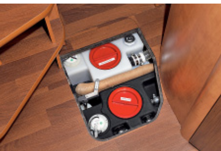
Gut gemacht: Die Versorgungstanks stehen samt Ablasshahn gut erreichbar im beheizten Doppelboden.
