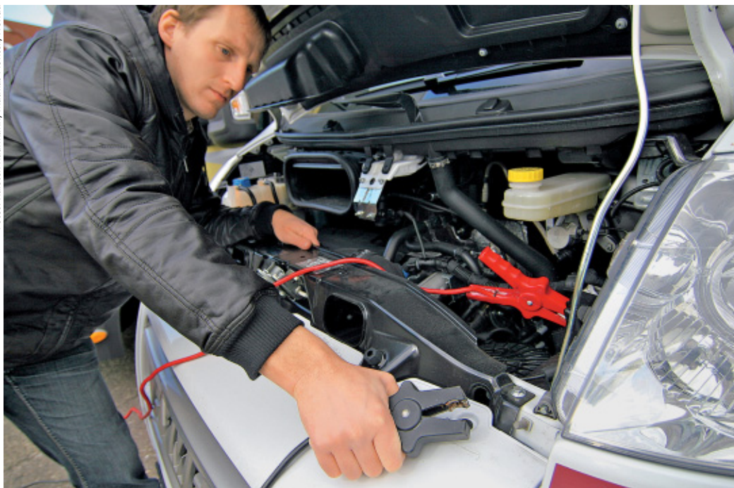
Der Masseanschluss ist gut erreichbar als Gewinde ausgeführt.
