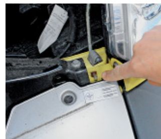
Der Masseanschluss ist gut erreichbar als Gewinde ausgeführt.
