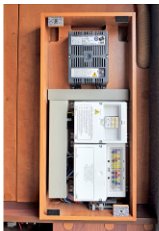
Vorbildlich: Die Elektrozentrale baut Carthago leicht zugänglich in der Heckgarage des Integrierten ein.
