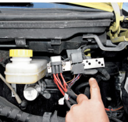
Die Leiste für Relais und Sicherungen ist als Masse-Anschluss ebenso tabu wie der dahinter befindliche Halter des Scheibenwischermotors.
