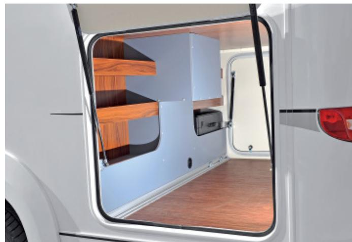
Regale helfen, in der großen Heckgarage Ordnung zu halten. Die beiden Klappen links und rechts halten Gasdruckstoßdämpfer offen.
