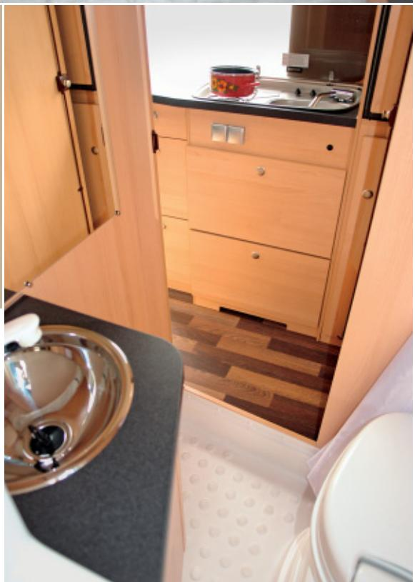
Die Längsküche fällt angesichts der kompakten Größe des Mobil überraschend großflächig aus. Links neben dem Zweiflammen-Herd von Dometic schnippeln Koch und Köchin auf einer 48 mal 34 Zentimeter großen Fläche Gemüse – und das in einer angenehmen Arbeitshöhe von 94 Zentimetern. Die Glasabdeckung lässt sich mit einem Hebel an der Wand fixieren. Allerdings hat der Herd keine elektrische Zündung.
