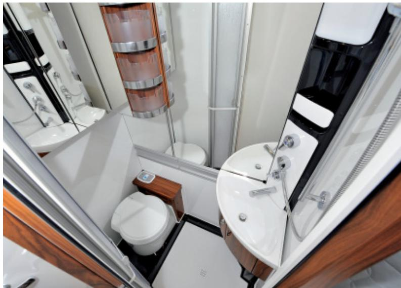
**Interessante Konstruktion im Bad. Das Waschbecken hängt gut zugänglich unter der Duschsäule in der Ecke. Um beim Duschen mehr Freifläche zu erhalten, wird es über das WC geschoben. Eine Klapptür verhindert, dass das Mobiliar nass wird. Ein Vorhang trennt das Bett vom Mittelteil des Mobiils.**
