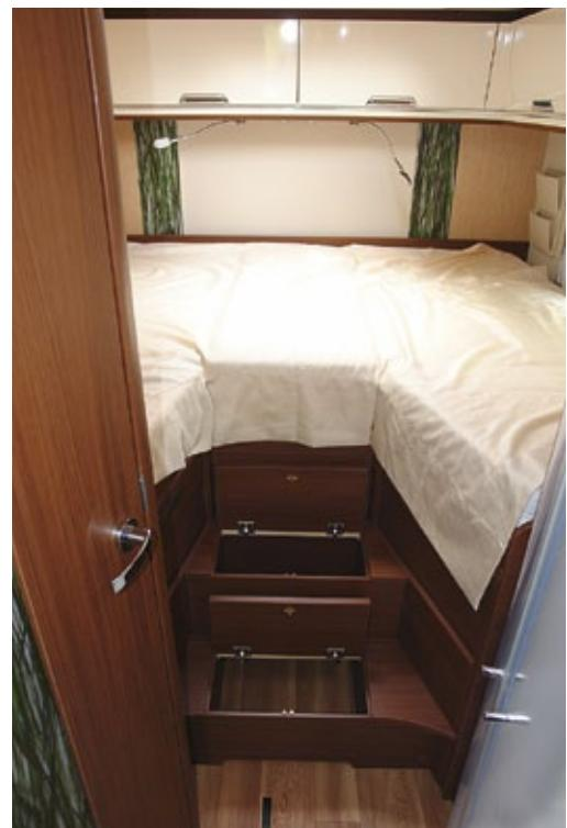
*Zwei Stufen mit angenehm großen Tritten führen hoch in die beiden Längsbetten. Beide Stufen können auch als Stauraum genutzt werden.*
