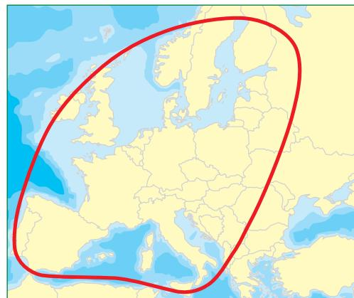
**Die rot umrandete Fläche bildet die Ausleuchtzone für den Satelliten Astra 1 ab. Die Ausleuchtzone gibt das Gebiet an, in dem das Signal eines bestimmten Satelliten zu empfangen ist, und ist je nach Spiegel unterschiedlich groß.**
