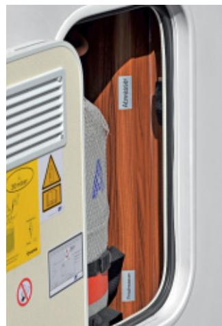
Ablashähne für Frisch- und Abwasser sind im Gasflaschenkasten montiert.
