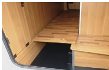
Dank klappbarer Bodenplatten lässt sich die Heckgarage im Ecovip 300 variabel nutzen.
