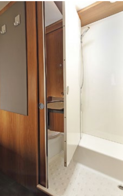
Im Bad des Magic Edition T 1 DB kommt eine um 90 Grad schwenkbare Wand zum Einsatz. Auf ihrer Vorderseite sind das Waschbecken und ein Spiegel montiert, die Rückseite mit Duscharmatur dient als Spritzschutz.
