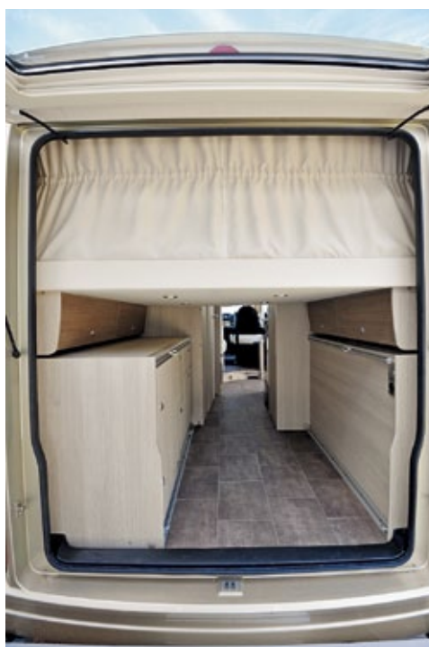
Die Idee mit dem Hubbett im Heck passt ausgezeichnet zum Konzept des Brevio. Es ersetzt den klappbaren Rost und die lose auf den Möbeln liegenden Matratzen. Der Brevio gewinnt damit eindeutig an Attraktivität.
