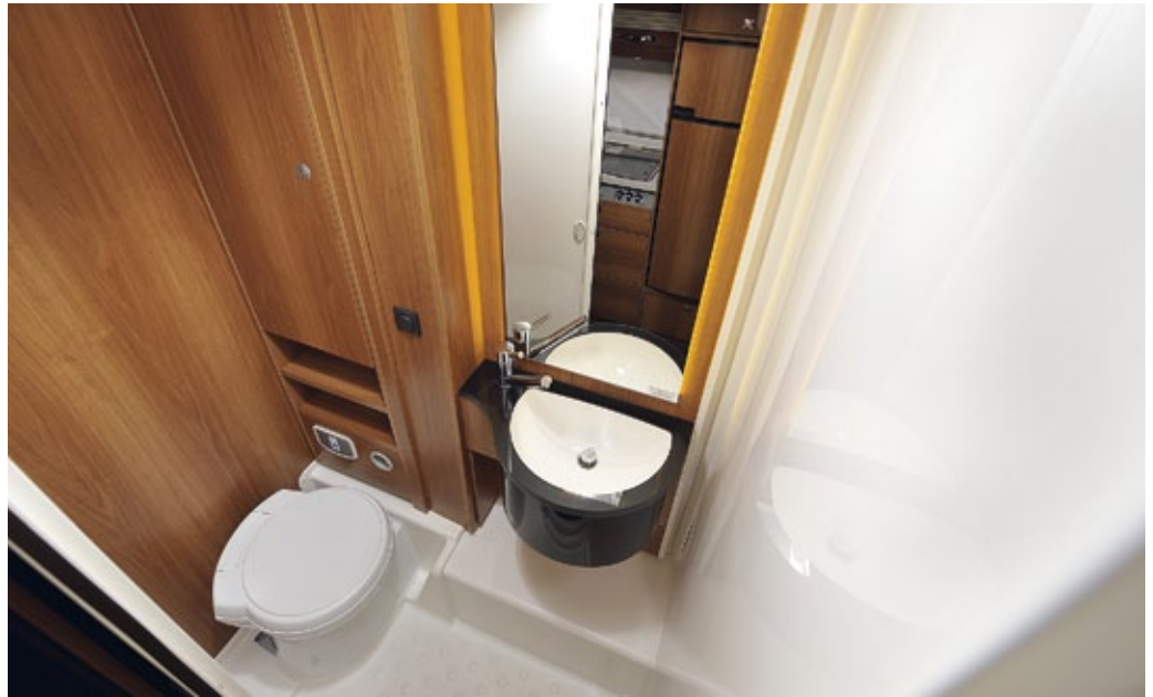
Im Bad des Magic Edition T 1 DB kommt eine um 90 Grad schwenkbare Wand zum Einsatz. Auf ihrer Vorderseite sind das Waschbecken und ein Spiegel montiert, die Rückseite mit Duscharmatur dient als Spritzschutz.
