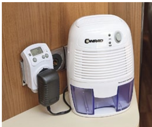
Kampf mit Kälte: Der Luftentfeuchter von Conrad leitet die Raumluft an einem Kühlelement vorbei, wo sie auskondensiert. Dazu gibt es ein programmierbares Schaltgerät.
