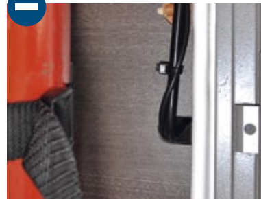
Der Gasflaschenkasten wurde nicht vollständig vom Wohnraum isoliert.
