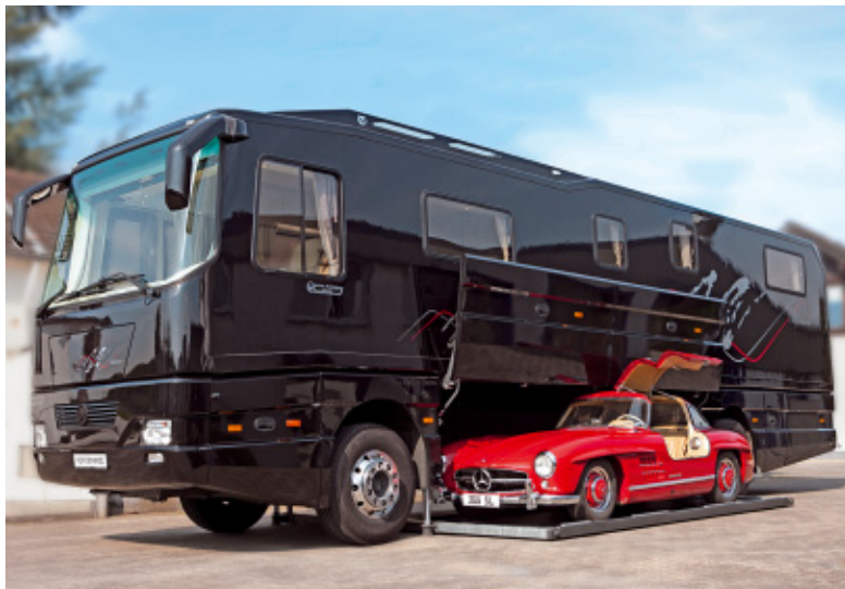
Der Volkner Performance nimmt zwischen seinen Achsen einen großen Pkw auf. Das Fahrzeug steht dann auf einer Plattform, die auf Knopfdruck von der Seite in die Garage gleitet.
