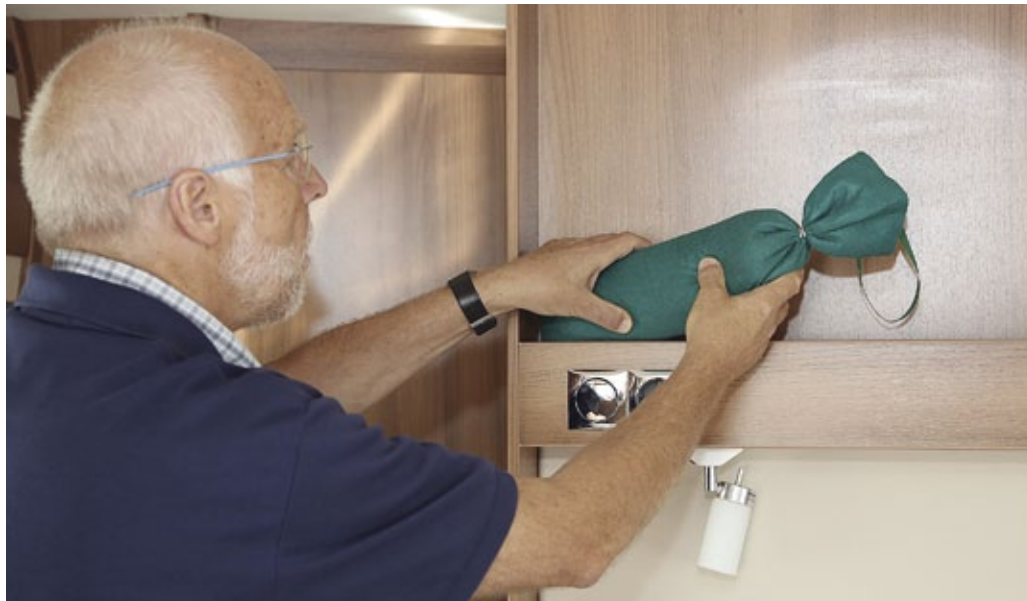
Der Multi Dry-Entfeuchter von Thomar kostet bei Fritz Berger 16 Euro, beinhaltet 1 kg Granulat und ist für Räume bis 35 m³ geeignet. Das reicht für ein Reisemobil. Die Mischung wird zu Hause im Backofen innerhalb von fünf Stunden regeneriert.
