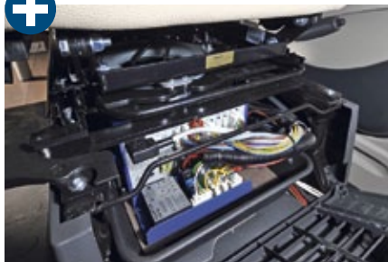
Unter dem Fahrersitz platziert, lässt sich die Elektrozentrale leicht erreichen und bedienen.
