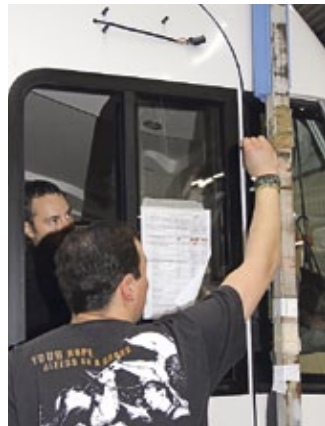
Die Frontmaske des Integrierten sitzt. Mit Lehre (außen) und Einstellschrauben (innen) wird das Spaltmaß fixiert.
