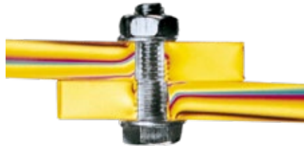
Spannungsspitzen an den Rändern von Nietlöchern oder Schrauben führen zu punktueller Krafteinleitung.
