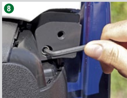
8 Grundplatte mit mitgelieferter Inbusschraube (M6x30) mit 5er-Inbusschlüssel anschrauben.
