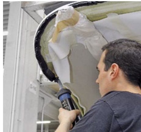
Auf die Frontmaske dieses integrierten wird vor der Montage rundherum Klebstoff aufgespritzt. Abschließend fährt eine spezielle Halterung die Front komplett ans Fahrzeug.
