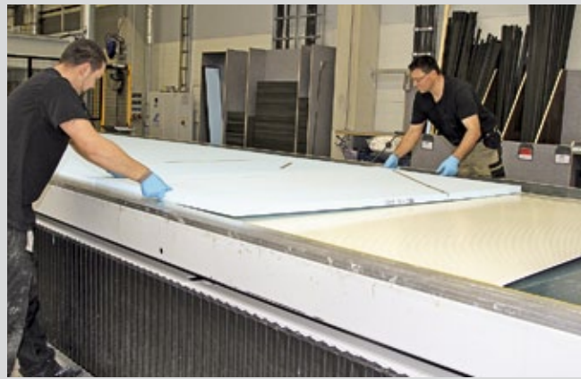
Die untere GfK-Schicht wurde schon mit Kleber besprüht, die Isolationsplatten werden nun bündig aufgelegt.
