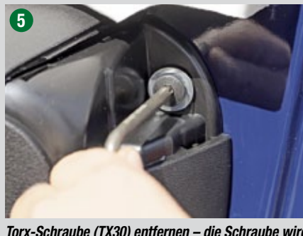
5 Torx-Schraube (TX30) entfernen – die Schraube wird nicht mehr benötigt. Im Lieferumfang finden Sie ersatzweise eine längere Inbusschraube.
