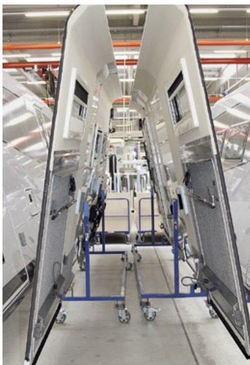
Die im Werk verklebten Sandwichplatten sind in die passende Form geschnitten (Bild oben), die Ausschnitte für die Fenster platziert.
