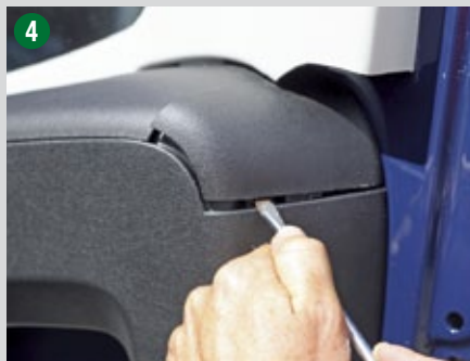
4 Hebeln Sie die Abdeckung der Armlehne mit einem breiten Schraubendreher nach oben heraus.
