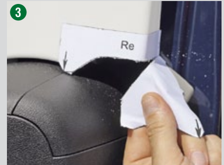
3 Sitzt der Schnitt nicht bis an die hintere Ecke, können Sie den letzten halben Millimeter nun abhebeln.
