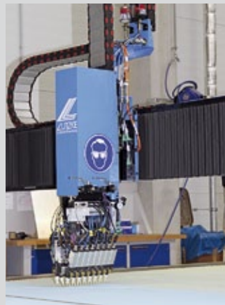
Exakter und sparsamer als manuelles Aufbringen mit dem Rechen: Vollautomatisch verteilt die Maschine bei Carthago den Kleber auf den Bauteilen. Aus Innenschicht, Isolierung und Außenschicht entstehen Wände, Böden und Dächer.
