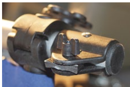
Zwei Einschraubösen ersetzen die Handgriffe oberhalb der Fahrertüren. Bolzen mit Schnellverschlüssen halten die vier Tragearme. Deren untere Aufnahme ist konstruktiv nicht solide gelöst (Bruch im Testverlauf).
