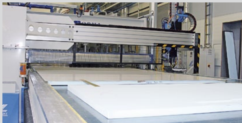
Exakter und sparsamer als manuelles Aufbringen mit dem Rechen: Vollautomatisch verteilt die Maschine bei Carthago den Kleber auf den Bauteilen. Aus Innenschicht, Isolierung und Außenschicht entstehen Wände, Böden und Dächer.
