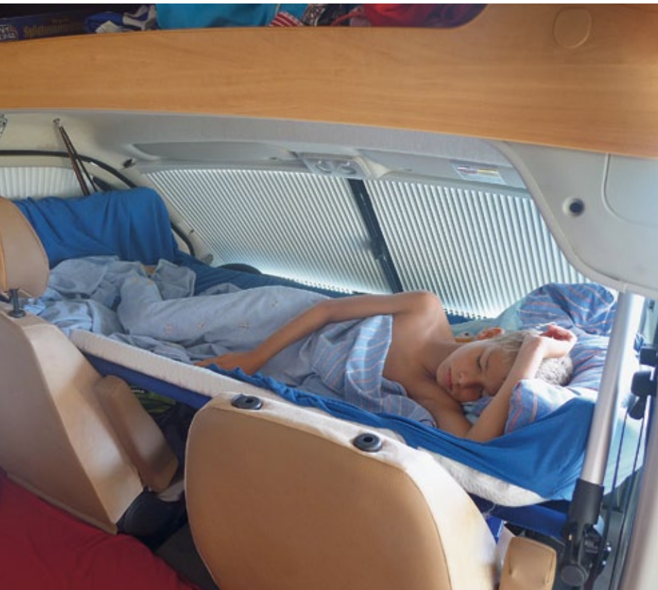
Das Movera-Bett erweitert jeden Ducato um ein Kinderbett (bis max. 50 kg). Der Aufbau benötigt – von komplett zerlegt bis fertig – rund zehn Minuten.
