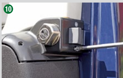
10 Drehen Sie beide Schrauben ins Schloss, die Sie in Schritt 6 demontiert haben. Bohren Sie die dritte Verschraubung vorne mit einem 2-Millimeter-Bohrer vor und drehen auch hier die Kreuzschlitzschraube ein.
