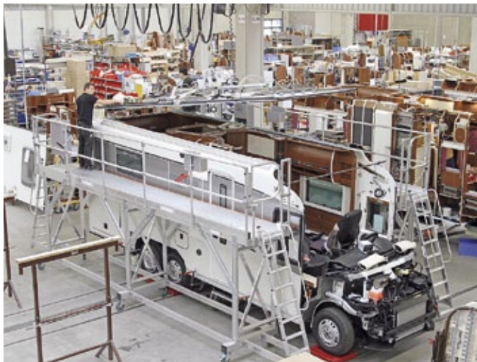
Im Werk in Aulendorf heben die Monteure das einteilige Dach auf einen Carthago-Chic e-line. Die umlaufende Verbindung sichert Hochleistungsklebstoff.
