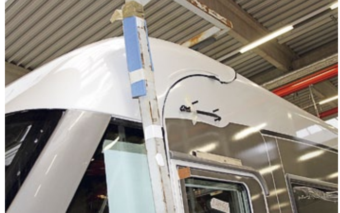
Auf die Frontmaske dieses integrierten wird vor der Montage rundherum Klebstoff aufgespritzt. Abschließend fährt eine spezielle Halterung die Front komplett ans Fahrzeug.
