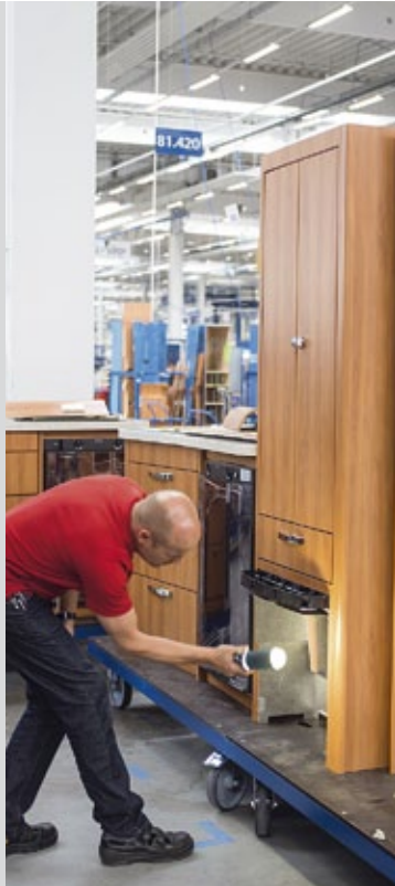
Blick tief hinein: Die Wohn- elemente fertigen nun Montage- trupps im Vorfeld der Bänder.
