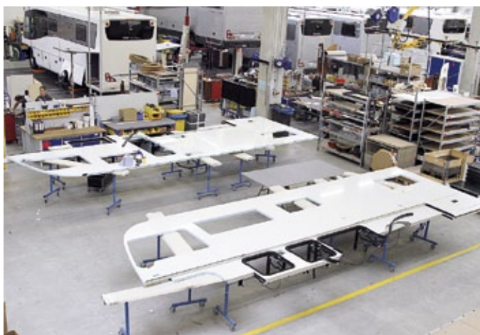
Die im Werk verklebten Sandwichplatten sind in die passende Form geschnitten (Bild oben), die Ausschnitte für die Fenster platziert.
