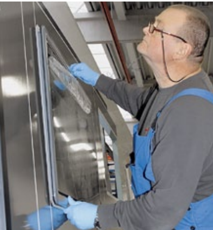
Fachleute ergänzen serienmäßige Dichtungen durch ein zusätzliches, klebendes Dichtungsband.
