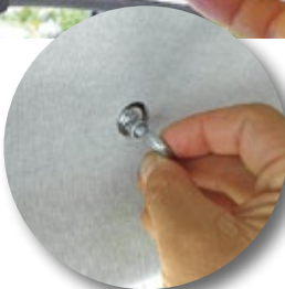
Zwei Einschraubösen ersetzen die Handgriffe oberhalb der Fahrertüren. Bolzen mit Schnellverschlüssen halten die vier Tragearme. Deren untere Aufnahme ist konstruktiv nicht solide gelöst (Bruch im Testverlauf).
