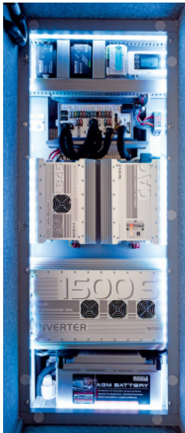
Montagefreundlich: Das Elektronik-Paket für die Platin-Edition können die Monteure im Werk übersichtlich und bequem auf der Werkbank vorinstallieren. Ein Schmuckstück: das Elektro-Paket fertig im Fahrzeug installiert.
