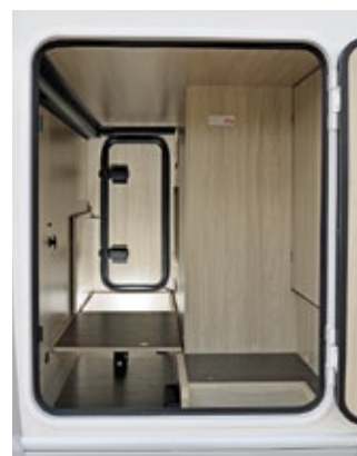
Von der Rückwand der Heckgarage lassen sich drei Holzplatten abklappen, so dass dann darunter ein separates Abteil entsteht und bei dem oberen Stauraum die Ladekante nicht stört.
