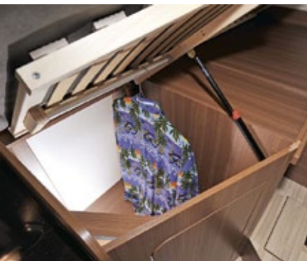
Die Kleiderstange fährt samt Lattenrost nach oben. Eine Arretierung am Gasdruckaufsteller verhindert, dass der Rost von selbst wieder zufällt.
