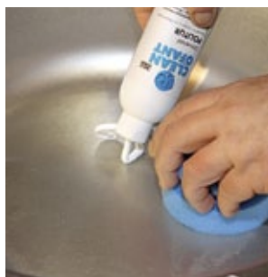
Die Politur ist ergiebig. Ein wenig Wasser hilft, den Schleiffilm geschlossen zu halten.
