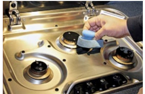
Polieren: Rolf Schöntag von Cleanofant macht sich mit einer Poliermaus und einer Universal-Politur an den Schmutz heran. Keine Frage: Je älter der Schmutz, desto mühseliger ist die Arbeit. Aber der Aufwand lohnt.
