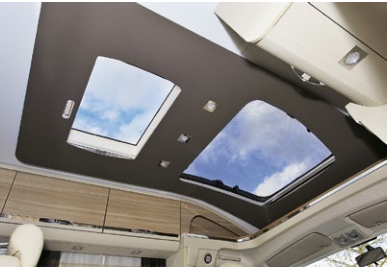
Voller Durchblick: Dachfenster und Heki, durch die reichlich Tageslicht ins Fahrzeuginnere gelangt, werden von einer eleganten Dach-Formverkleidung umrahmt.
