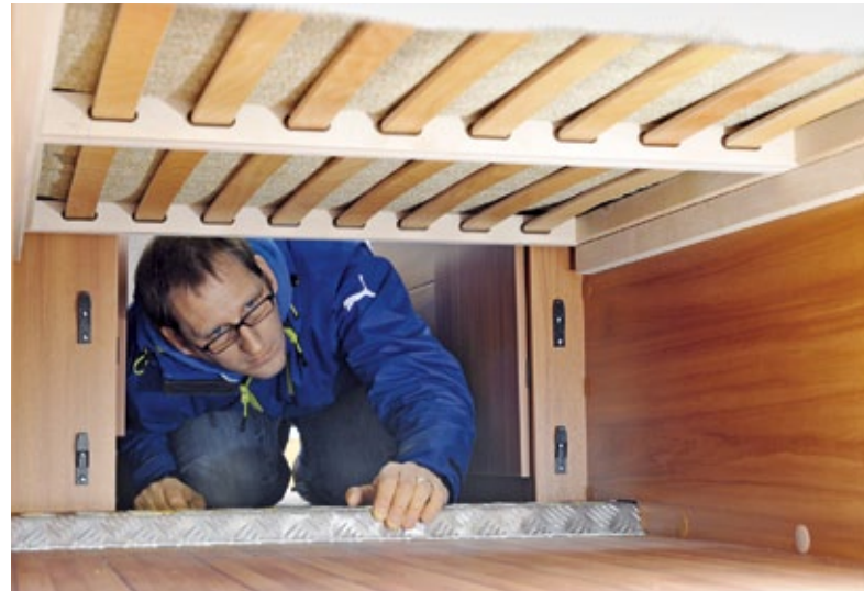
Der Raum unterm unteren Heckbett bietet sich für sperriges Gepäck an. In die vier schwarzen Kunststoff-haken lässt sich ein Schott zum vorderen Fahrzeugteil einhängen, damit beim Bremsen alles am Platz bleibt.
