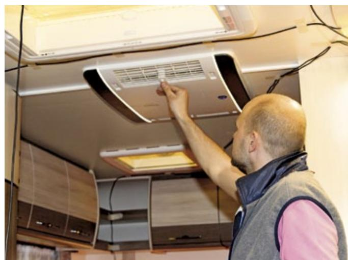
*Je vielfältiger der Luftstrom am Luftverteiler einstellbar ist, desto exakter lässt sich die Kaltluft im Reisemobil verteilen.*
