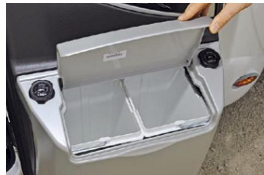
**Solide, praktisch und schick:** Die geschäumte Sicherheitstür verfügt über zwei Schlosser und zwei integrierte, herausnehmbare Abfalleimer.
