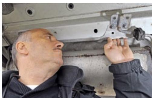
*Die Besichtigung des Unterbodens ist bei jedem Mobil angeraten. Hier ist eine Aufhängung falsch montiert.*
