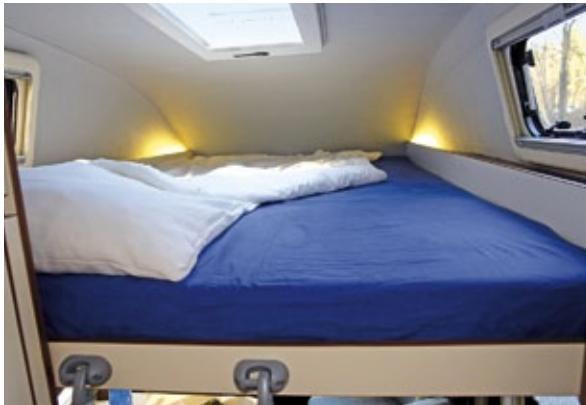
**Überm Dachbett bleibt ausreichend Kopffreiheit. Tagsüber heben es vier Gasdruckdämpfer unter die Decke. Die Sitzgruppe bleibt stets nutzbar.**
