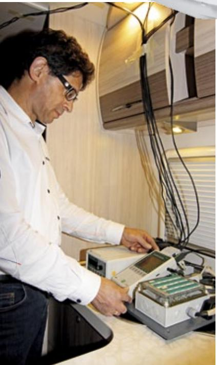
Messtechniker Fidelis Knaus überprüft vor dem Teststart in der Klimakammer Elektronik und Messfühler im Testfahrzeug.
