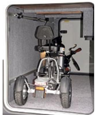
Ihn liefert der Hersteller für 600 Euro. Clever: Das Akkusystem ist so einstellbar, dass der Fahrer mit Strom aus dem ersten Akku startet und den Reserveakku erst für die Rückfahrt einschaltet. Je nach Ausstattung startet der Freeliner preislich bei rund 3.999 Euro. Zusammengeklappt auf 74 mal 63 mal 80 Zentimeter lässt sich der 32 Kilogramm schwere Roller (ohne Akku) mit etwas Muskelkraft problemlos in der Heckgarage verstauen.
