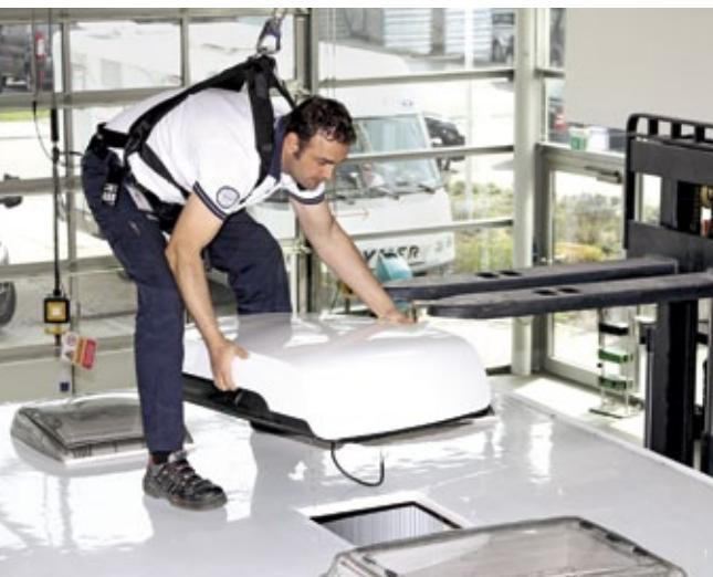
Dachfenster raus, Klimagerät rein: Die Nachrüstung von Dach-Klimaanlagen gelingt ohne großen technischen Aufwand.
