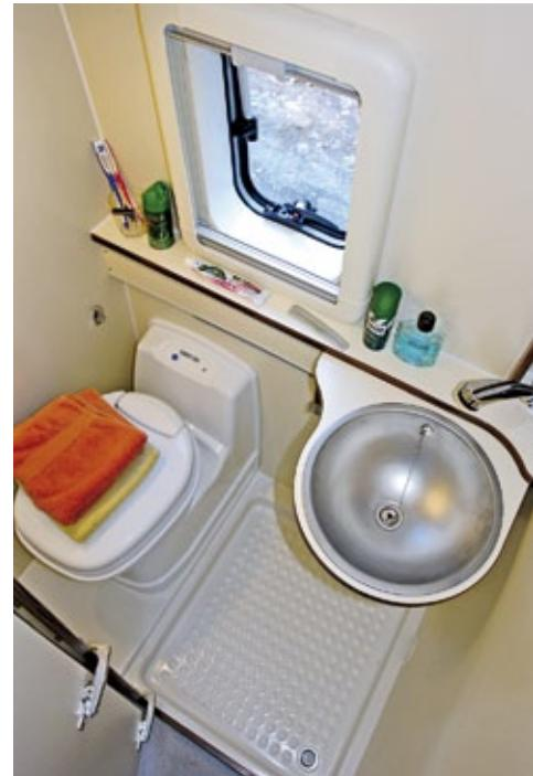
**Das Waschbecken in der sauber verfügten Nasszelle mit Fenster lässt sich nach links über die Kassettentoilette schieben. Dann bleibt genügend Raum zum Duschen.**
