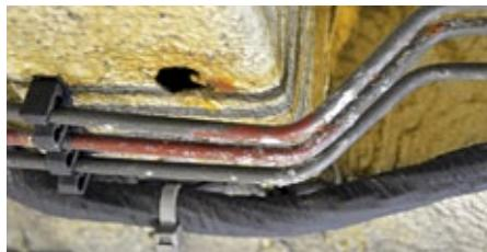
**Die Bremsleitungen zeigen beginnende Korrosion. Hier sollte ein Fachmann über den Austausch entscheiden.**
