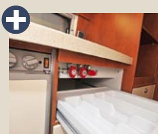
**Die Gasabsperrhähne sind tief auf Bodenniveau installiert.**
