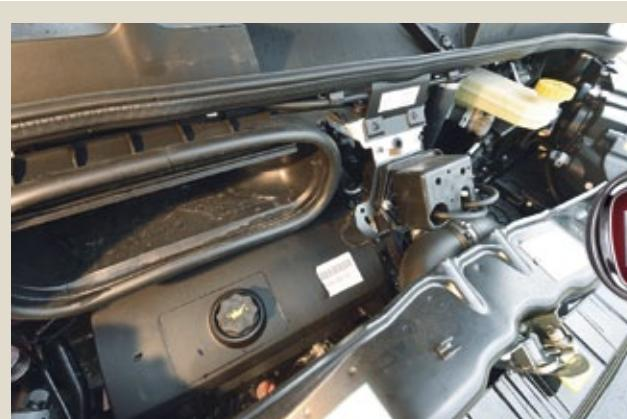
Motorraum Fiat: Der neue, demontierbare obere Querträger macht die Reparatur im Falle eines Crashes einfacher. Der Zugang zum Motor ist recht schmal – nichts für Hobby-schrauber.
