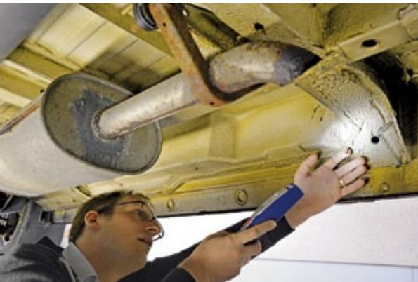
Dank Versiegelung des Unterbodens mit speziellem Fett hatte der Rost an diesem Sprinter bisher keine Chance.
