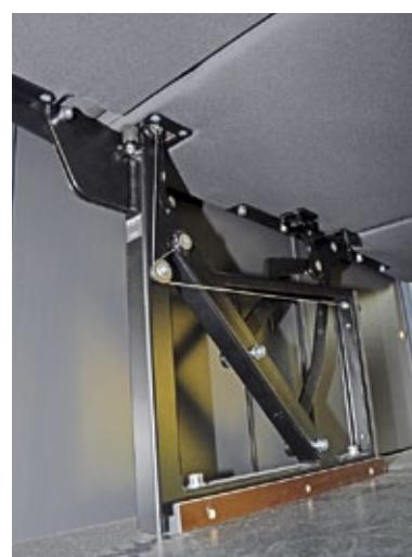
*Links oben: Der große Ladetunnel schluckt Mengen von Material. Das Bett ist richtig bequem. Oben rechts: Die Sitzbankteile lassen sich mit wenigen Handgriffen herausnehmen. Übrig bleiben die Träger samt Klappmechanismus. Sie lassen sich mit je zwei Inbusschrauben von der Bodenplatte abnehmen.*
