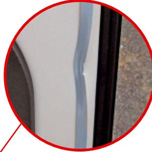
*Ob Dometic, Tegos oder Rhein Composite – alle Hersteller haben die Einbruchssicherheit ihrer Türen im Laufe der Zeit verbessert. So scheiterte ein Einbrecher bei dieser Tür am stabilen Schloss. Bei früheren Modellen bestand die Türfalle häufig aus Kunststoff.*
