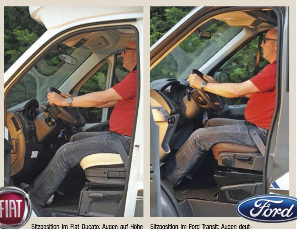
Sitzposition im Fiat Ducato: Augen auf Höhe der Frontscheiben-Oberkante. Steile Position, Fahrer oberhalb des Armaturenbretts, Lenkrad nur längsverstellbar. Die angezogene Handbremse blockiert die Drehung des Fahrersitzes.
