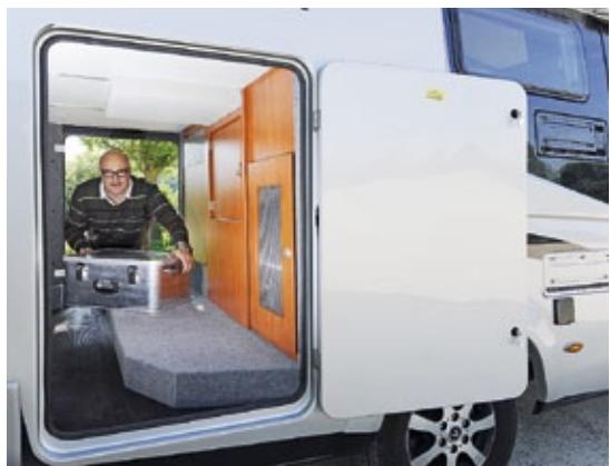
Die Heckgarage bietet zwei Fahrrädern reichlich Platz und ist auch sauber ausgekleidet. Das Ausschnittmaß der Aufbautür ist zu klein, die Höhe der Stufen dafür zu groß.
