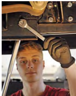
Rahmenverstärkung (oben) und Anbauteile müssen vorbereitend montiert werden.
