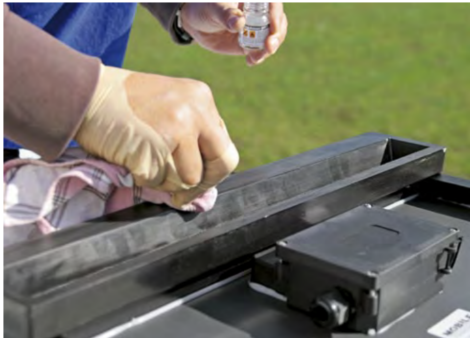
Vor dem Kleben müssen die Klebeflächen vom Dach und der Solarhalter chemisch vorbereitet werden. Abhängig vom Kunststoff müssen Aktivator und/oder Primer eingesetzt werden.
