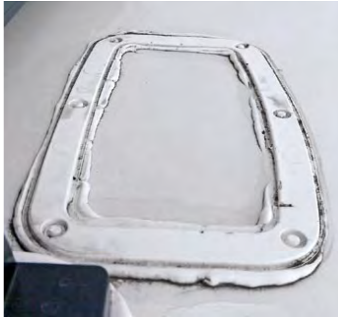
Unfallanalyse: Von diesem Dach löste sich das Solarmodul samt Solarhalter. Auf dem Dach haftet noch perfekt der Kleber. Die Klebeverbindung zum Solarhalter hingegen war mangelhaft.
