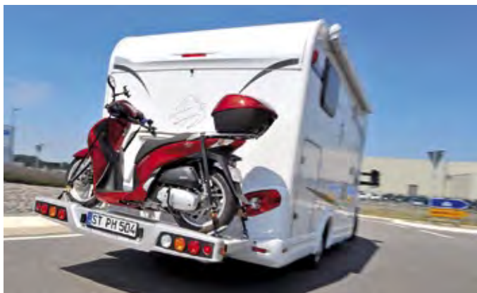
Solide: Die steife Verschraubung am Fiat-Rahmen sollte auch eine rasante Fahrweise überstehen. Maximal 150 Kilogramm darf das Backpack tragen.
