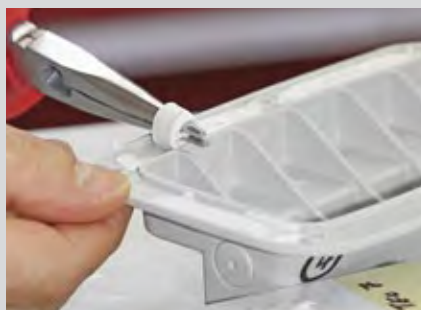
Der Idealfall: Beim Raupenschältest löst sich die Klebewurst nur, wenn der scharfe Cutter nachhilft (oben). Rechts im Bild versagt der Kleber auf dem Phaeson-Halter und löst sich rückstandsfrei.
