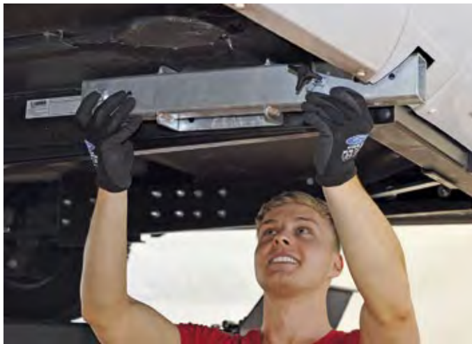
Rahmenverstärkung (oben) und Anbauteile müssen vorbereitend montiert werden.
