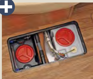
Die Versorgungstanks werden im beheizten Zwischenboden montiert.
