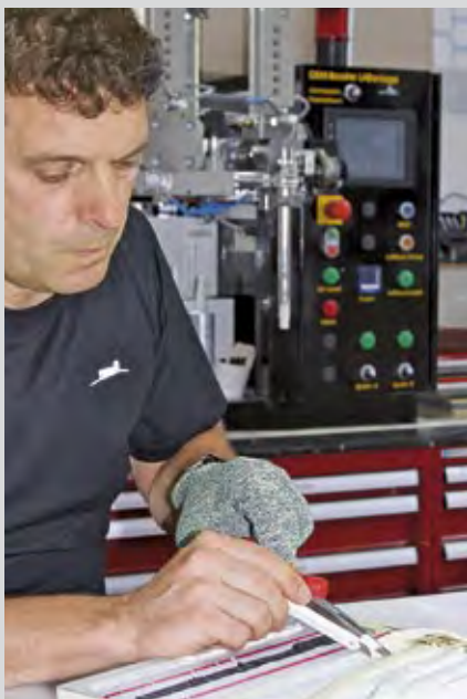
Der Idealfall: Beim Raupenschältest löst sich die Klebewurst nur, wenn der scharfe Cutter nachhilft (oben). Rechts im Bild versagt der Kleber auf dem Phaeson-Halter und löst sich rückstandsfrei.
