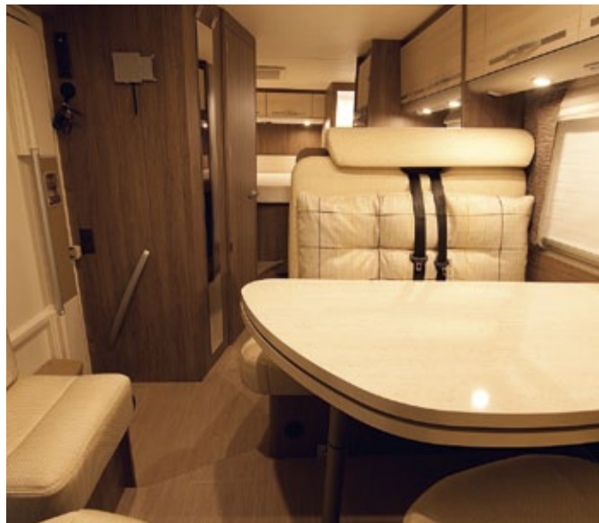
Zahlreiche LED-Spots beleuchten das Mobil recht gleichmäßig. Der Verzicht auf 12-Volt-Halogenleuchten spart deutlich Strom.
