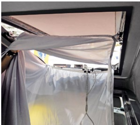
Terra Camper zeigt eine flexible Innendusche für den T5. Mit Faltwanne und Vorhang, damit man auch in Island mal innen duschen kann.
