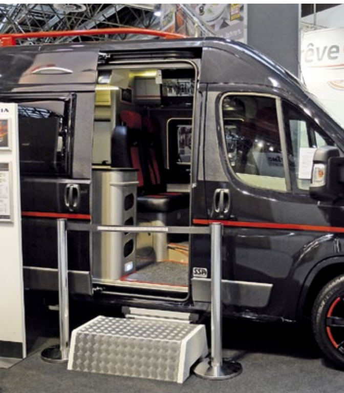
Adria zeigte in einem Konzeptcar eine komplett elektrische Schiebetür für den Fiat Ducato – mit Sensoren gegen versehentliches Einklemmen.
