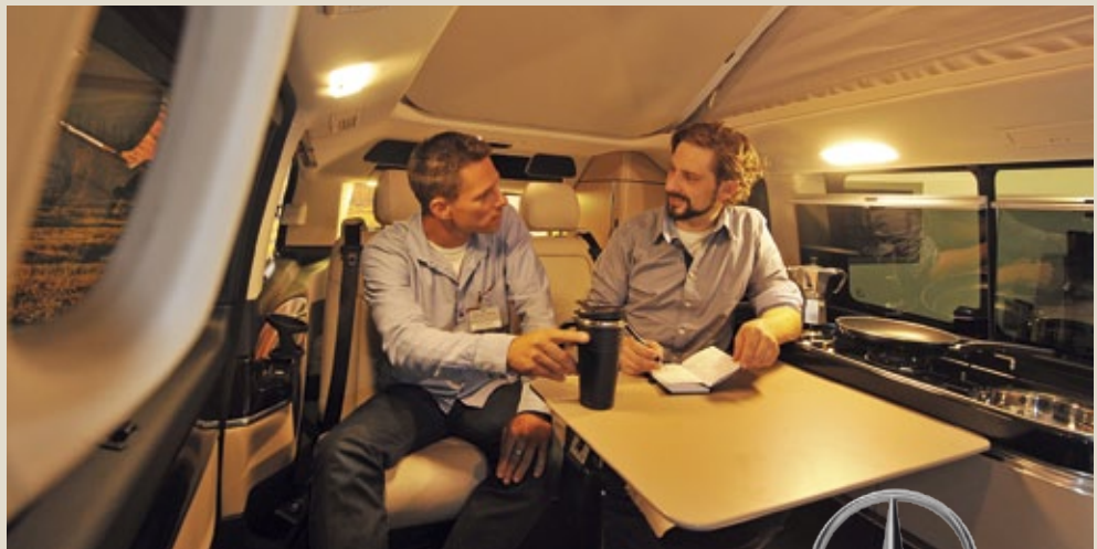
„Function follows form“, heißt es bei Mercedes. Der Designer gab die Richtung vor. Der Tisch hängt jetzt ähnlich wie im California in der Küchenzeile und ist eingeklappt rollgelagert verschiebbar. Einen Tisch in der Schiebetür gibt es aber nicht.
