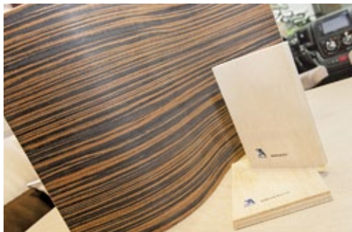
Leichtholz: Frankia setzt zunehmend auf Möbel aus dem sehr leichten Balsaholz, bekannt aus dem Modellbau.
