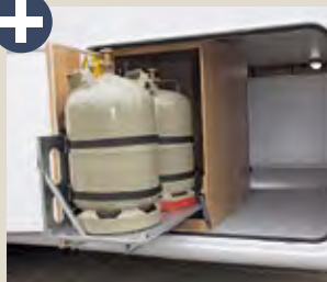
Der ausziehbare, stabile Auszug erleichtert den Gasflaschentausch.
