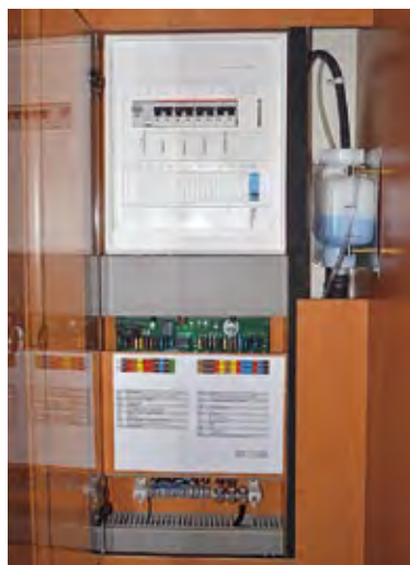
Energiezentrale: Die Sicherungskästen und der Ausgleichsbehälter der Warmwasser-Heizung sitzen gut erreichbar im Kleiderschrank des Midi-Liners.
