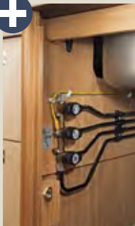
Die Gasabsperrhähne sind gut erreichbar und gekennzeichnet im großen Küchenauszug montiert.
