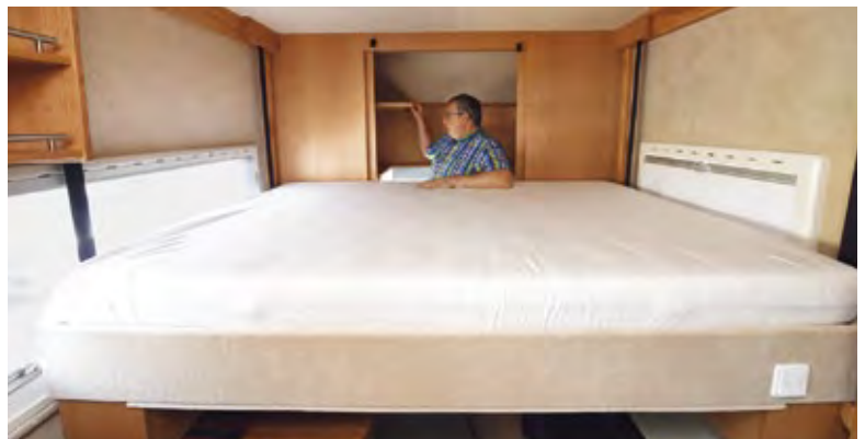
Das Hubbett sitzt in der Mitte des Mobils. Dopfer hat hierfür eine eigene Konstruktion, die in Schienen geführt wird und heruntergelassen sicher aufliegt.
