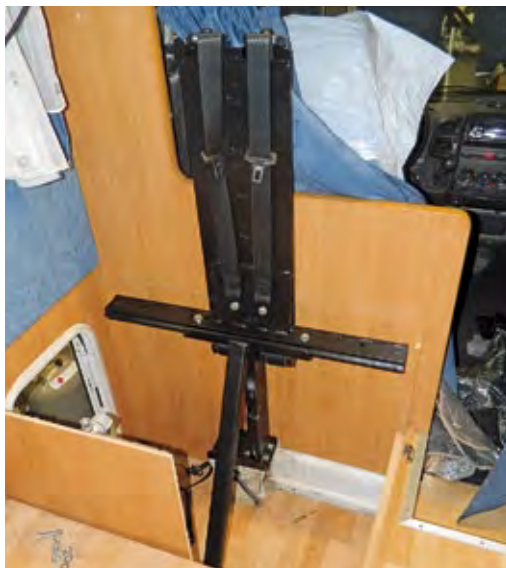
Große Herausforderung: Im Sitzkasten soll der Gaskasten für zwei 11-kg-Flaschen erhalten bleiben. VSR setzt den Gurtbock auf den Knotenpunkt, wo das Al-Ko-Tiefrahmenchassis mit dem Ducato gekoppelt wird. Das Rückenpolster wurde von VSR durch weitere Polster verlängert, das Design passt ganz ordentlich.
