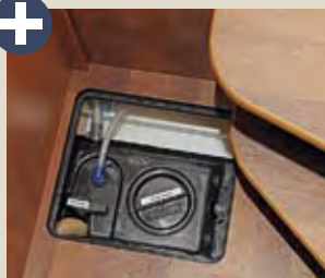
Der Ablasschieber für den Abwassertank liegt im Wageninneren.
