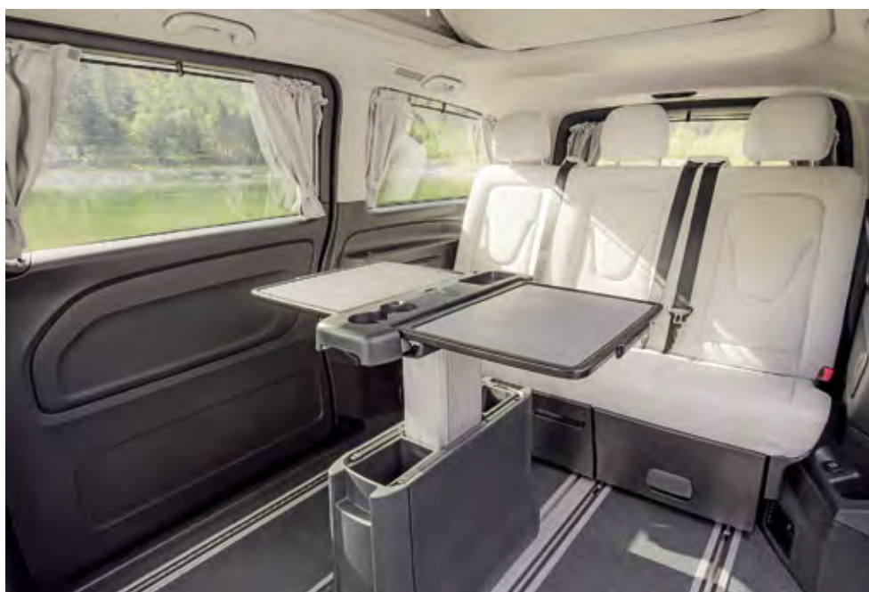
Verschiebbare Dreiersitzbank, klappbarer Tisch mit Hubstütze – die Verdunklung erfolgt klassisch über Vorhänge.
