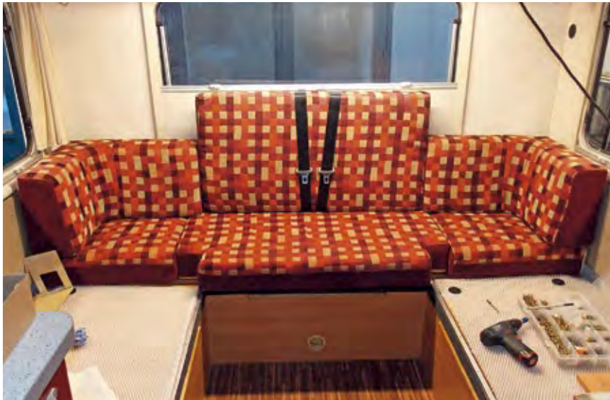
Im Eura Mobil mussten zwei Sitzplätze im Heck entstehen. Die Crux: Erst durch die Montage eines soliden Hilfsrahmens konnte VSR eine stabile Basis als Lager für den Gurtbock schaffen. Der Gurtbock stützt sich im Sitzkasten nach vorne ab (Bild rechts). Die etwas höheren Rückenpolster stören den Gesamteindruck kaum.
