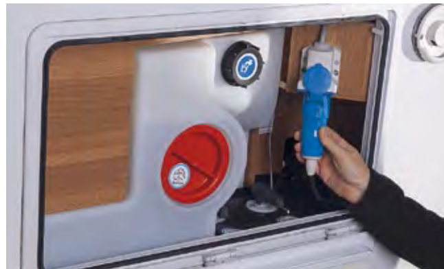
Gut gelöst: Den Gasflaschenkasten integriert Weinsberg in die voluminöse Heckgarage. Die Service-Box nimmt den Frischwassertank und weitere nützliche Features wie den Elektroanschluss und die Ablasshähne auf.
