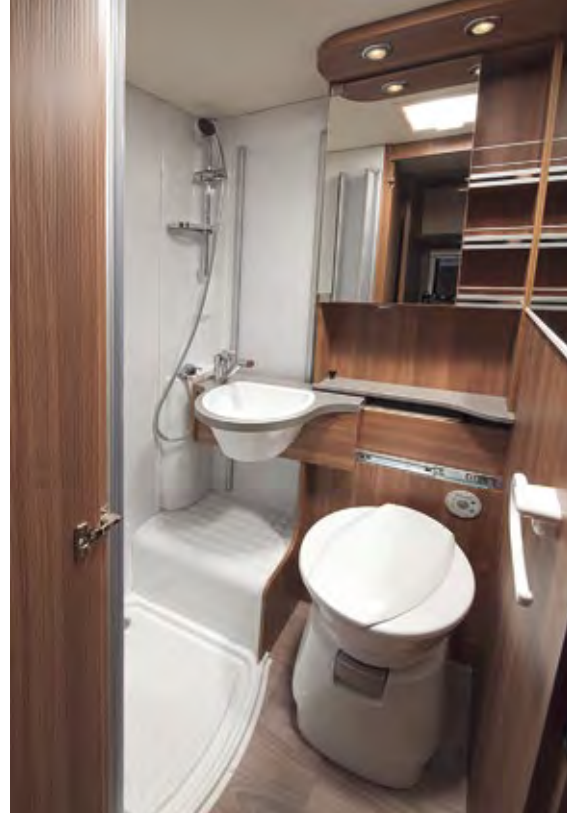
Mitgedacht: Um Platz zu sparen, lässt sich das Waschbecken an einer Metallschiene entlang zur Seite in die Duschkabine schieben (Bild rechts) und dann die drehbare Kassettentoilette nutzen. Die beiden Kleiderschränke befinden sich unter den Einzelbetten (Bild oben).
