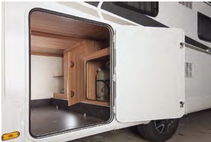
Gut gelöst: Den Gasflaschenkasten integriert Weinsberg in die voluminöse Heckgarage. Die Service-Box nimmt den Frischwassertank und weitere nützliche Features wie den Elektroanschluss und die Ablasshähne auf.
