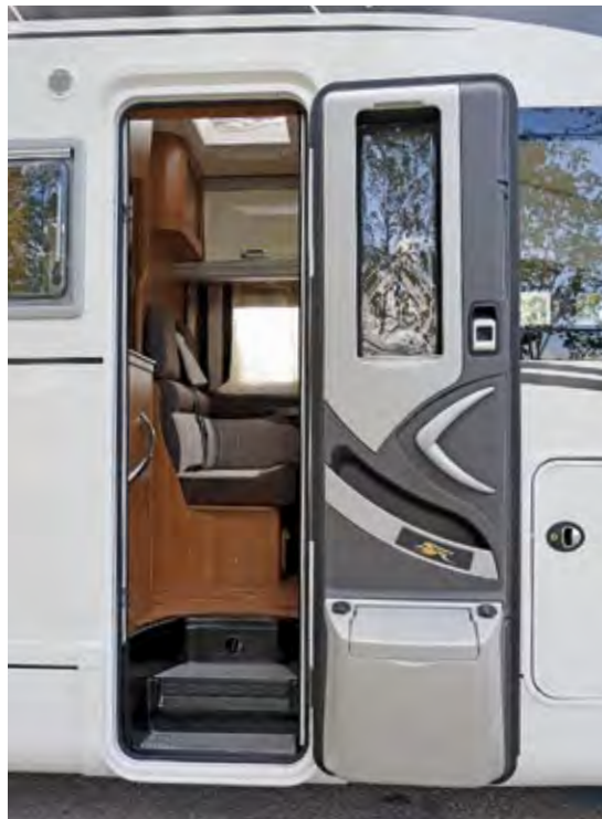
So soll es sein: Die Dometic-Tür schließt leicht, dank zweier Schlösser sicher und ist an die Zentralverriegelung gekoppelt. Elegant: der Abfalleimer mit zwei Behältern.
