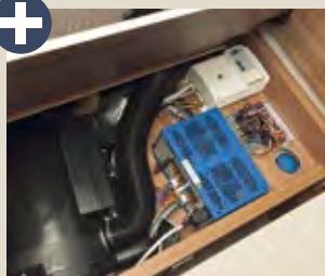
In der Sitzbank befinden sich die Heizung und die Elektrozentrale.
