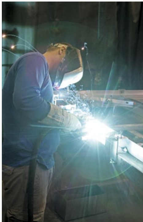
Hightech trifft auf Handarbeit: Links bearbeitet ein CNC-Fräser ein Aluminium-Profil auf den hundertstel Millimeter genau, rechts muss der Schweißmeister selbst Hand anlegen, um Alu-Profile zu einem Rahmen zu verbinden.
