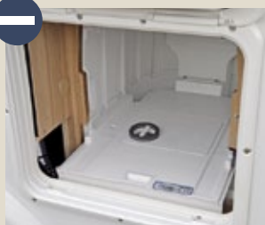
Toilettenschacht ohne Abdichtung und mit offenen Holzkanten.
