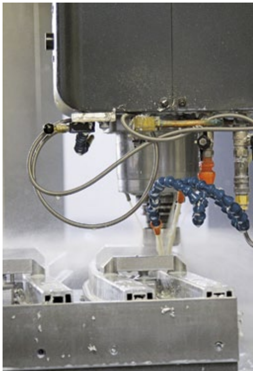
Hightech trifft auf Handarbeit: Links bearbeitet ein CNC-Fräser ein Aluminium-Profil auf den hundertstel Millimeter genau, rechts muss der Schweißmeister selbst Hand anlegen, um Alu-Profile zu einem Rahmen zu verbinden.
