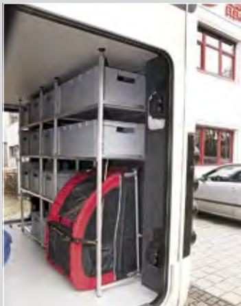
**Idea-Systec:** Idea fertigt individuelle Regalsysteme mit Justiertellern, die leicht herausnehmbar sind. Ebenso umfasst das Angebot Campingmöbel-Stausysteme, Auszugsysteme für Heckgaragen und Fahrradhaltersysteme (Pedi-Packer).
