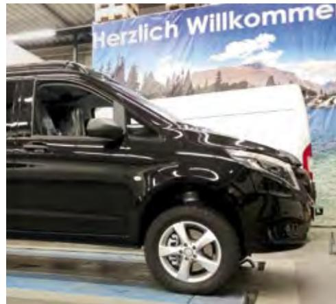
*Vier Luftfedern von VB Airsuspension machen aus dem Fahrwerk des Vito und der V-Klasse von Mercedes ein Multitalent. Für schnelle Autobahnfahrten lässt sich das Normalniveau um 30 Millimeter absenken, für Geländefahrten die Bodenfreiheit um bis zu 60 Millimeter erhöhen. Die Extremlagen sind geschwindigkeitslimitiert.*
