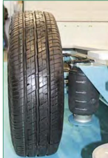
*Goldschmitt bringt die Hinterachse des Ducato-Heavy-Fahrwerks mit einer Zusatzluftfeder auf eine Achslast von 2.700 Kilogramm.*
