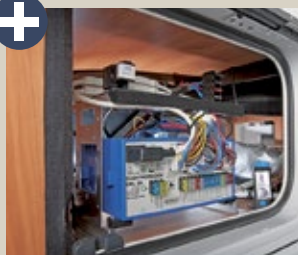
Elektroblock und Frostschutzventil der Heizung sind gut erreichbar.
