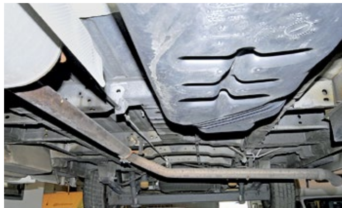
Erweckt Vertrauen: der Unterboden mit unversehrtem Korrosionsschutz.
