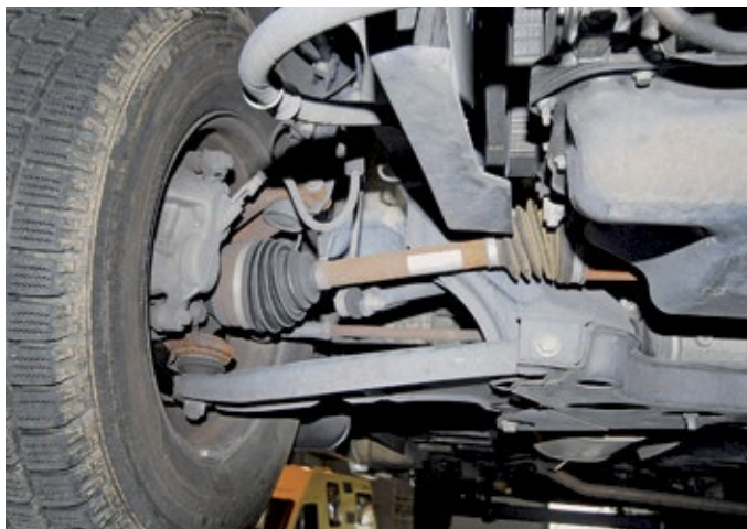
Motor, Getriebe und Achsmanschetten sind trocken.
