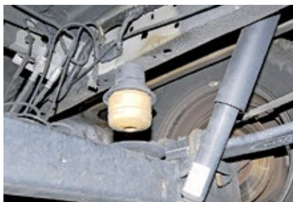
Neuwertige Anschlagpuffer an den Blattfedern der Hinterachse.
