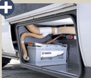
Batterie im gut zugänglichen, beheizten Staufach.
