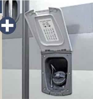
Reifeninnendruckwerte gut sichtbar im Deckel des Dieseltanks.
