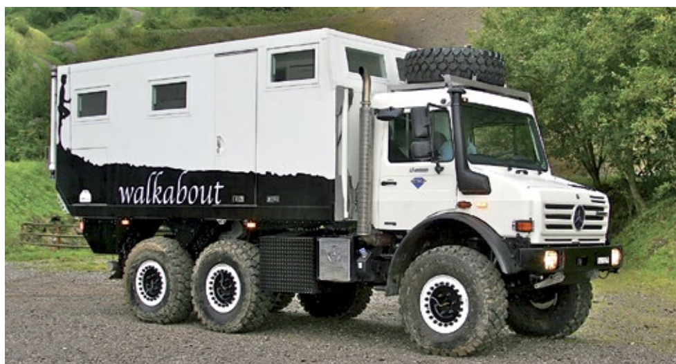
Die Basis des Expeditionsfahrzeugs MD52h von Unicat aus Dettenheim ist der Unimog U4000 als Dreiaxser.
