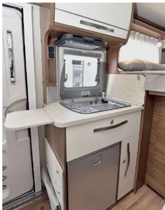
Hymer stattet die Küche mit einem Kompressorkühlschrank, einer Schublade, einem Auszug und einer abklappbaren Arbeitsfläche aus.
