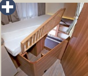
Aufstellbarer, stabiler Holzlattenrost mit Zugang zum Heckstauraum.
