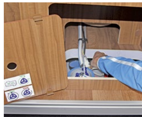
Den Hahn zum Ablassen des Frischwassers sollte Hymer besser erreichbar im Fahrzeuginneren platzieren.
