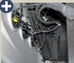
Kabel am Unterboden in Kabelschläuchen und gut fixiert.
