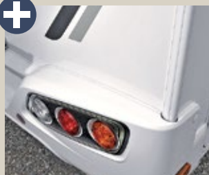
Heckstoßfänger sauber angepasst und mit Gummikeder.
