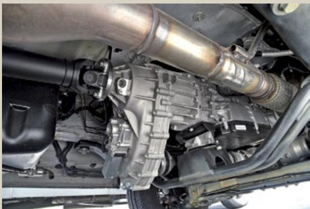
**Kraftübertragung:** Eine kurze Kardanwelle führt vom Verteilergetriebe nach vorne zum Vorderachs differenzial. 35 Prozent der Antriebsleistung werden an die Vorderachse geleitet, 65 Prozent nach wie vor über die verkürzte Kardanwelle an die Hinterräder.
