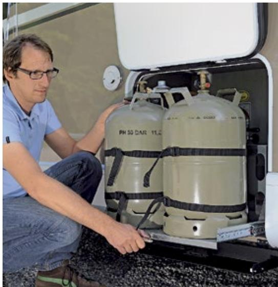
**Perfekt gestalteter, stabiler Gasflaschenkasten: Der ausziehbare Schlitten für rückenschonenden Flaschentausch lässt sich arretieren.**
