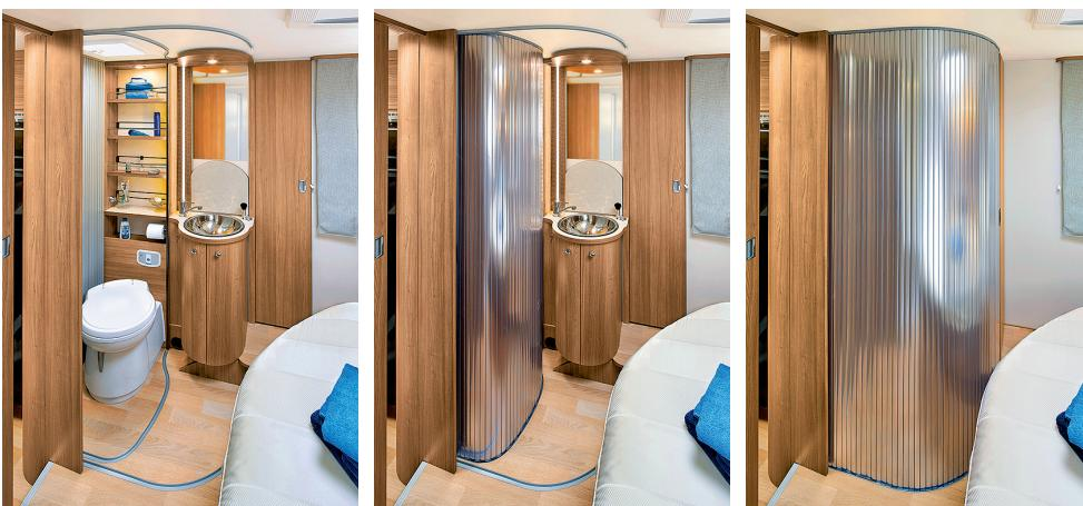
*Variables Bad im teilintegrierten Rapido 680FF: Das linke Bild zeigt den WC-Raum offen. Beim mittleren schottet die Gliedertür nur das WC ab; Waschtisch und Durchgang bleiben frei. Rechts ist der gesamte WC-Raum geschlossen.*
