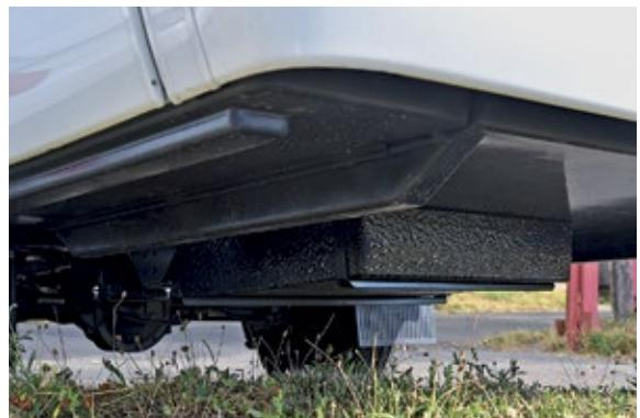
**ML-T 580 4x4:** Gleicher Bordstein, gleiche Situation. Immerhin 36 Zentimeter verbleiben zwischen der Halterung des Abwassertanks und der Straße. Der ML-T 4x4 streckt sein Heck in die Höhe.
