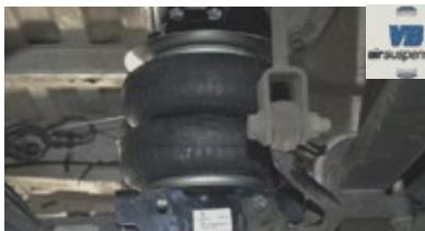
**Zusatlluftfeder-Hinterachse für das blattgefederte Fiat Serienfahrgestell**
