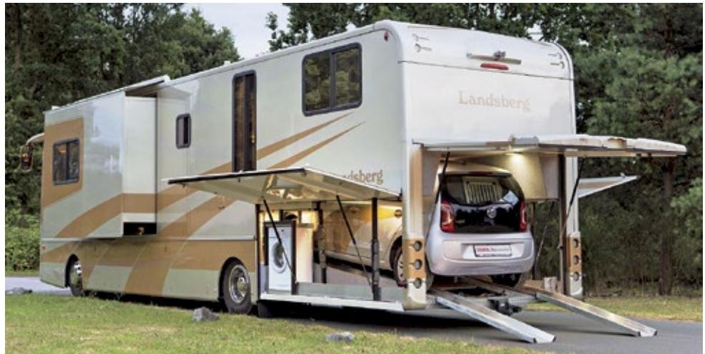
einen elektrisch ausfahrbaren Slide-out verzichten. Geschlafen wird im 567.600 Euro teuren Liner, der auf Basis des MAN-TGM mit 6,9 Liter-Turbodieselmaschine und 290 PS Leistung über die Straße rollt, in einem erhöht montierten Queensbett mit gigantischen Ausmaßen.
