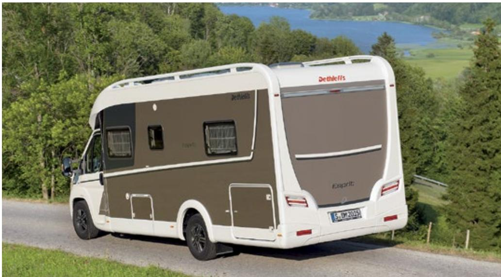
**Der siebenteilige Stoßfänger des neuen Hecks sieht gut aus und ist sehr reparaturfreundlich aufgebaut. Option: die Dachreling.**
