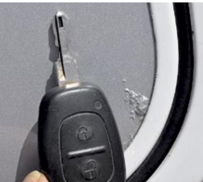
**Korrosion – ärgerlich, aber an der Klappe in der Größe verschmerzbar.**
