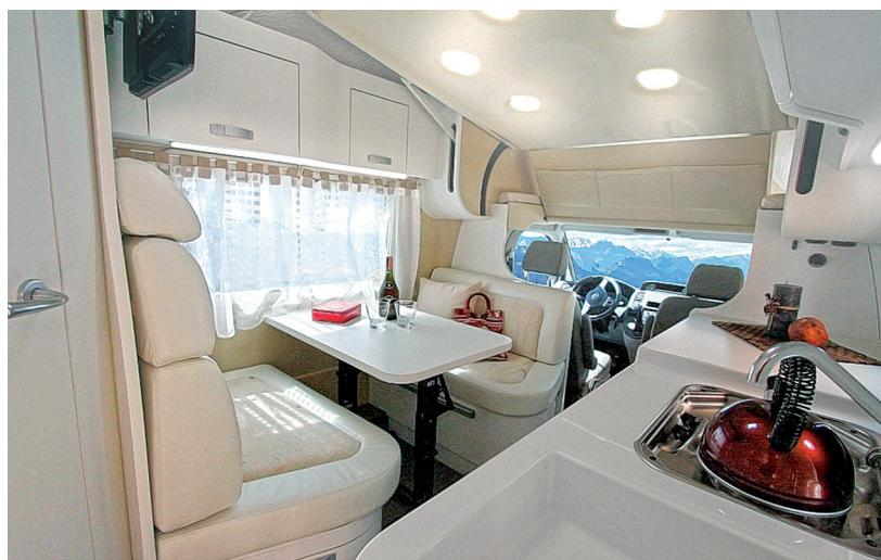
ke sind die extrem abgerundeten und äußerst eleganten Möbel. Die Wandstärke der Fahrzeuge beträgt 30, die des Bodens 40 Millimeter. Wingamm isoliert seinen Aufbau mit 25 Millimeter dickem Polyurethan. Auch Aufbautür und Klappen sind geschäumt, damit keine Kältebrücken entstehen. Ebenfalls typisch für die Marke sind die unterhalb des Heckstoßfängers angebrachten Zusatzstauräume. Als Basisfahrzeuge dienen VW und Fiat Ducato. gam
