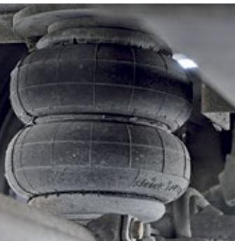
**Bei Luftfedern sollte der Käufer die Bälge genau kontrollieren.**
