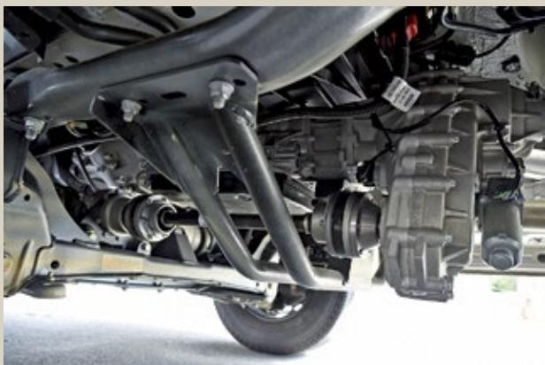
**Antriebswellen:** Vom Vorderachs differenzial aus gelangt die Antriebskraft, wie bei einem Frontantrieb, über die beiden Halbwellen zu den Rädern. Statt einer mechanischen Sperre kommen die Bremsen zu Einsatz, die durchdrehende Räder abbremsen und damit das Drehmoment an die Räder mit Traktion weiterleiten.
