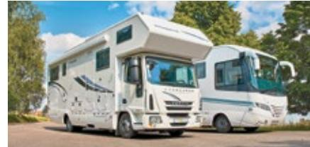
**Durch Leichtbau kann Phoenix auf MAN TGL oder Iveco Eurocargo Luxusmobile bis neun Meter Länge unterhalb der 7,5-Tonnengrenze realisieren.**
