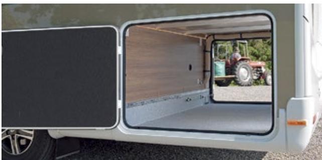
**Die zweitürige Heckgarage mit rutschhemmendem Boden ist mit LED-Band gleichmäßig ausgeleuchtet. Praktisch: die 230-Volt-Steckdose.**
