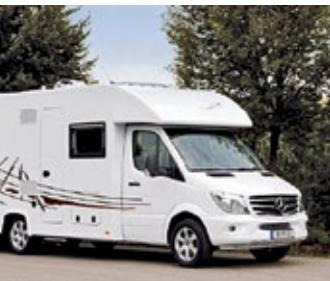
**Ein Teilintegrierter in der Premium-Klasse: Der Dreiachser Dopfer Individual 582 TI baut auf dem Mercedes-Benz Sprinter auf.**
