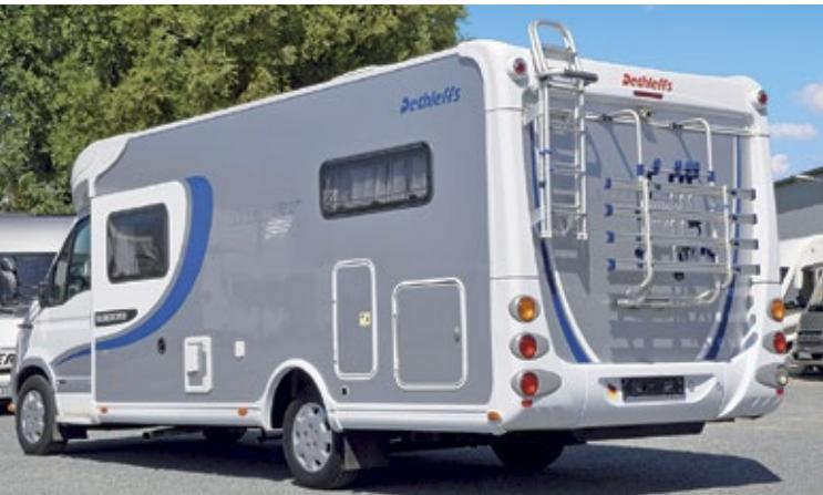
**Die Heckleiter führt auf das begehbarе Dach. Am Heck sitzt ein Fahrradträger.**
