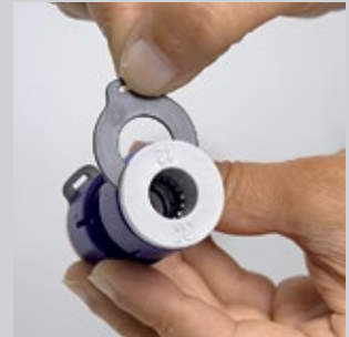
Der Klemmring lässt sich mit dem Fingernagel entfernen, die Verbindung durch Herausziehen des Rohrs öffnen. Nach dem Einsetzen des Rings kann der Verbinder wiederverwendet werden.
