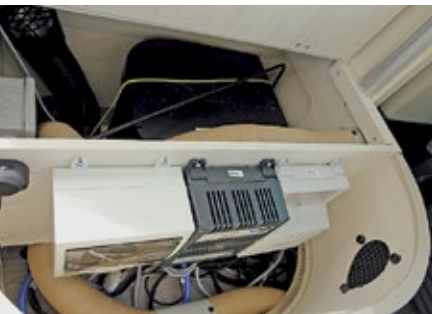
Guter Zugriff: Bordelektronik und Heizung sind in einer der Längsbänke integriert.
