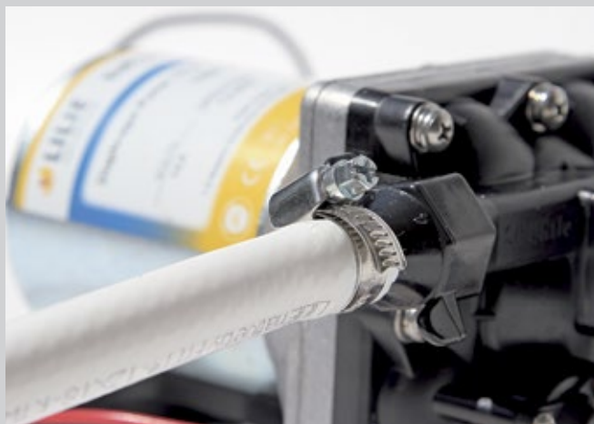
Aufschraubtüllen: Die Anschlüsse an der Pumpe sollten von Hand fest zugezogen und danach mit Werkzeug um eine weitere halbe Umdrehung festgezogen werden. Kein Teflonband oder sonstige Dichtmittel verwenden. Sie verhindern, dass der Dichtkonus sauber schließt, der Anschluss kann nicht ordentlich dichten.
