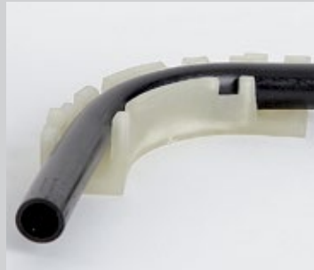
Das Rohr wird einfach von oben in den zuvor verschraubten Verlegebogen gepresst. Dabei wird das Rohr leicht hochovalisiert verformt.
