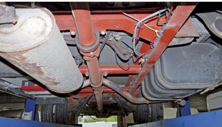
Nur die Auspuffanlage zeigt leichten Flugrost.
