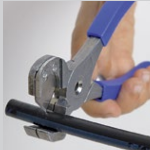
Obligatorisch: Die Rohrschere schneidet UniQuick-Rohre, ohne sie zu quetschen oder zu beschädigen.
