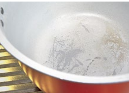
Brunner: Die Antihafbeschichtung löst sich nach dem ersten Einsatz.
