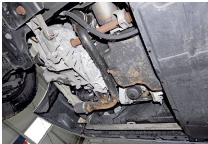
Motor und Getriebe sind rostfrei, dicht und ohne Ölverlust.
