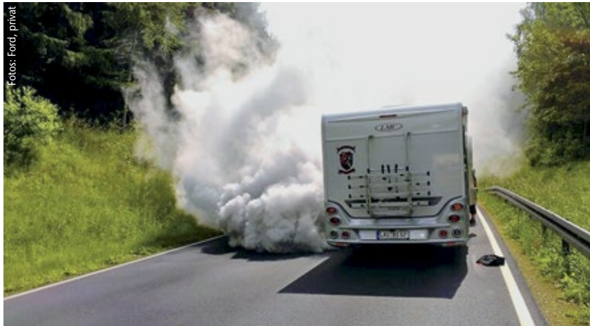
Sorgenkind: Der 2,2-Liter-TDCI-Dieselmotor, gebaut von Anfang 2004 bis Oktober 2011, ist in vielen Reisemobilen geplatzt.
