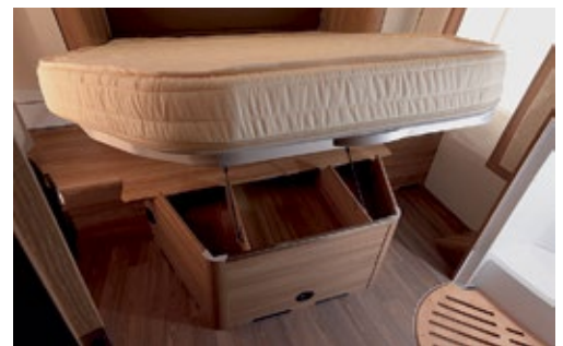
Der Lattenrost mit Alurahmen ist per Gasdruckdämpfer aufstellbar. Darunter kommen Staufächer zum Vorschein.
