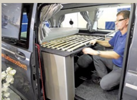
Köhler Wohnmobile zeigt den Sunvan V24 mit einem ausziehbaren Lattenrostsystem, das mit wenigen Handgriffen herausnehmbar ist.
