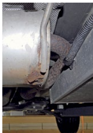
Der Schalldämpfer wird fällig: Ein fettes Rostloch verrät den nahenden Exitus (oben links).
