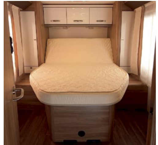
Um das Queensbett im kompakten Aviano I 700 unterzubringen, hat der Hersteller die Liegefläche verschiebbar konstruiert. Hierbei stellt sich das Kopfende auf.
