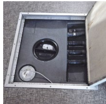
Frostsicher – der Wassertank ist im doppelten Boden untergebracht.
