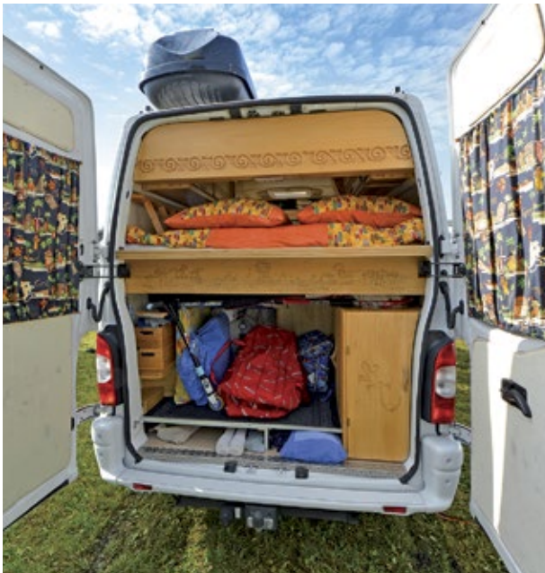
Klaus Schäfer aus Schweinfurt ist gelernter Karosseriebauer. Er zauberte aus einem Opel Movano ein kleines Kunstwerk. Innen kleidete er das Gefährt mit Paulowniaholz aus, verpasste ihm einen doppelten Boden, um Surfbretter und Kitesegel unterzubringen.
