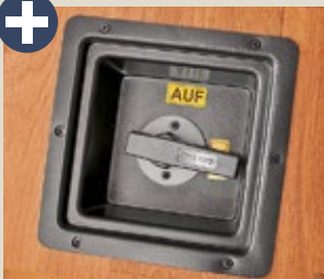
Der Ablasschieber des Abwassertanks lässt sich von innen betätigen.
