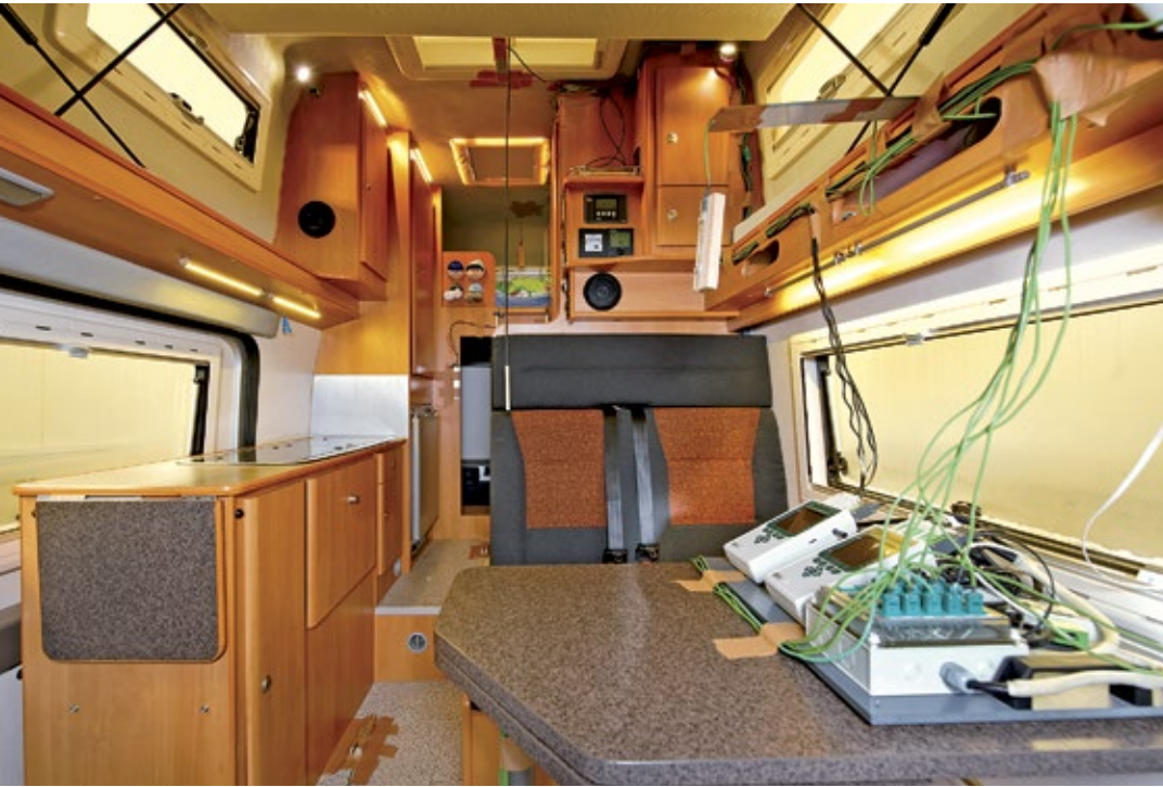
Mess-Equipment satt: Truma Messtechnik der Fidelius Knaus installiert zahlreiche kombinierte Temperatur-/Feuchte-messfühler im Bresler. Ein Datenlogger zeichnet im Sekundentakt Werte auf und überträgt sie direkt in die Messzentrale.
