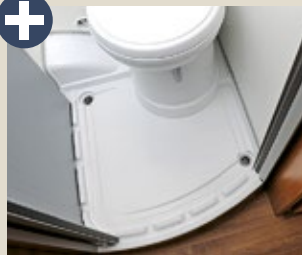
Hymer versieht die Duschtasse mit zwei Wasserabläufen.
