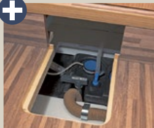
Der Ablasshahn für das Abwasser wird vom Wohnraum aus bedient.
