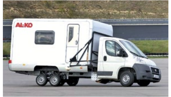
Ausgetretene Pfade verlassen: Diesen Fiat Ducato testete Al-Ko mit einer leichten Doppelachse mit 13-Zoll-Rädern. Der Ducato gewinnt an Komfort, denn mit kleinen Rädern sind die ungefederten Massen leichter. Mittlerweile ist dieses Fahrwerk erhältlich.
