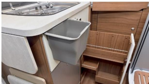
**Die Küche ist durchdacht. Die Verlängerung der Arbeitsfläche ist jetzt höhengleich mit der Arbeitsplatte. Der Müllheimer lässt sich aus dem Auszug nehmen und an der Besteckschublade einhängen.**
