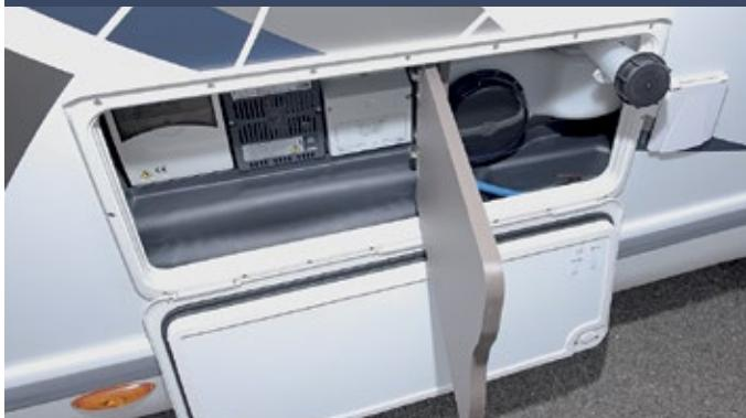
**Gut gemacht: Chausson integriert Elektrozentrale und Frischwassertank** nebst dazugehörigen Einfüllstutzen in die Service-Box, die sehr gut von außen zugänglich ist. So ist alles auf einmal zu erreichen und bleibt obendrein sauber.
