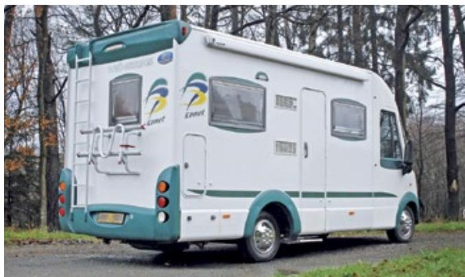
**Markantes Heck:** Heckspoiler mit dritter Bremsleuchte, Heckleiter und ein moderner Heckleuchtenträger. Dazu die typischen Applikationen an Ecken und Kanten.
