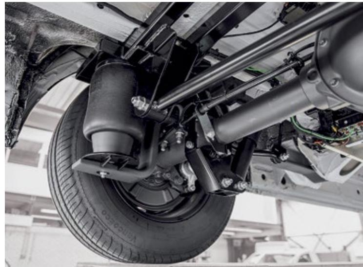
*VB-Airsuspension hat die Luftfederung für die Mercedes-Sprinter-Hinterachse überarbeitet.*
