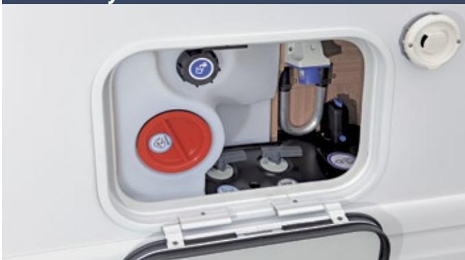
**Bestens: Im isolierten wie beheizten Außen-Servicefach montieren die Knaus-Techniker Frischwassertank, Ablashähne für Frisch- und Grauwasser sowie das Ablassventil für den Boiler.** Auch hier findet sich also alles auf einen Blick.
