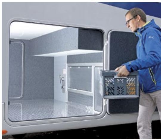
**Gut nutzbar:** die zweitürige Garage. **Haltbar:** der Tränenblechboden. **Sicher:** Zurrösen fürs Ladegut. **Hinter den Blechen der Vorderwand:** Teile der Elektrik. Links davon: der Anschluss für die Außendusche.
