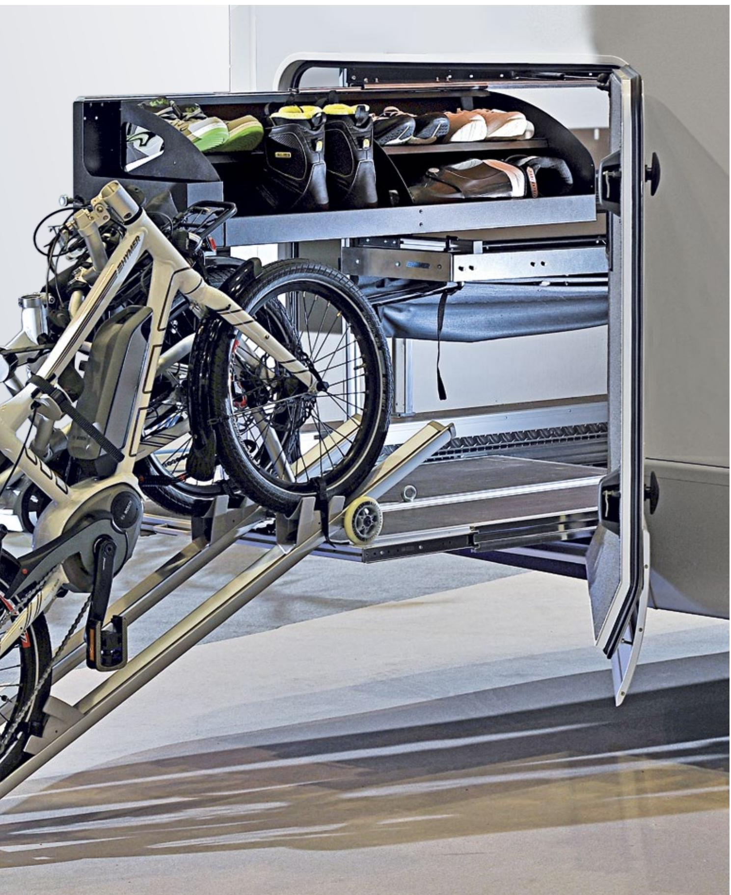
und schneidern ihren Kunden maßgefertigte Regalsysteme in die Heckgarage oder Vollauszüge in kleinere Staufächer. Hinderliche Bodensockel werden kurzerhand umbaut, das Regal an die individuelle Geometrie von Staufach und Heckgarage angepasst. So gelingt es, auch die letzte Ecke effektiv zu nutzen.
