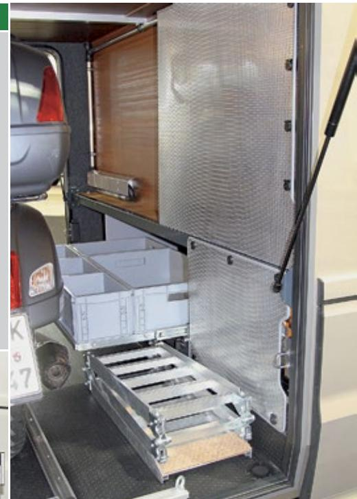
*Mit Auszügen nutzt Chrismotec Staufächer und Ecken in der Heckgarage. Der Roller wird mit Spanngurten sicher verzurrt.*
