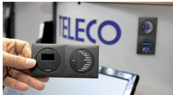
Mit einem neuen Bedienteil für automatische Sat-Anlagen erleichtert Teleco seinen Kunden das Ansteuern von verschiedenen Satelliten. Das neue Bedienteil lässt sich jetzt nicht mehr nur senkrecht, sondern auch waagerecht ins Fahrzeug einbauen. Anschalten, Satellit auswählen und schon richtet sich die Antenne auf den gewünschten Satelliten aus. Zehn gängige Satelliten wie Astra 19, Hotbird oder Eutelsat 5 sind direkt anwählbar.
