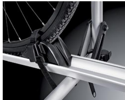
*Mit verschiebbaren Ratschengurten sichert der Camper die Laufräder, die Rahmenhalter lassen sich abschließen.*
