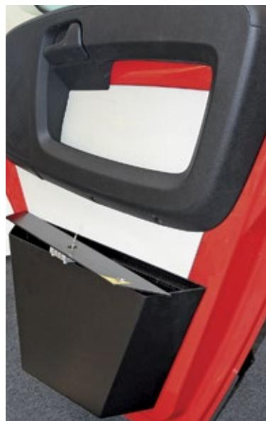
Mit wenig Aufwand lässt sich ein einbruchssicheres Fach von Mobilsafe an die Beifahrertür eines Ducatos schrauben. Es wird einfach anstelle des Kartenfachs an die vorhandenen Gewindebuchsen angebracht.
