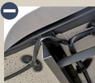
**Rahmenverlängerung mit spitzen Kanten dicht unterm Stoßfänger.**
