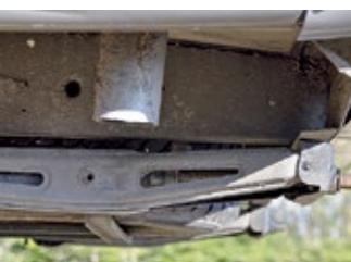
Gerade bei mehreren Mitreisenden stabilisieren die Heckstützen das Fahrzeug im Stand enorm.
