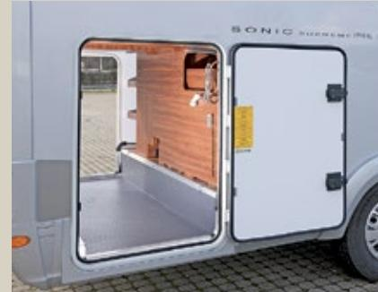
Praxisgerecht: In den Doppelböden integriert Adria große Schuhfächer, die sich über Luken im Wohnraumboden beladen lassen. Die geräumige Heckgarage wird mit zwei Ladetüren bestückt. Das erleichtert die Beladung mit Fahrrädern oder zusätzlichem Gepäck. Auf dem Maxi-Chassis (1.800 Euro) besitzt der Sonic Supreme reichlich Zuladereserven.
