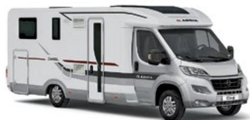
**Basisfahrzeug:** Fiat Ducato mit originalem Tiefrahmenchassis, 2,3-Liter-Turbodiesel mit 109 kW (148 PS), Sechsgang-Schaltgetriebe, Frontantrieb
