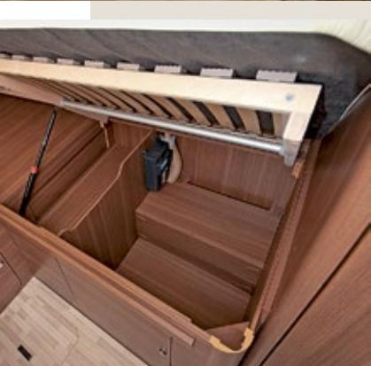
**Bei aufgestelltem Lattenrost ist der Kleiderschrank darunter auch von oben aus zugänglich. Auch der 230-Volt-Sicherungsautomat ist so leichter zu erreichen.**
