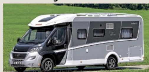
**Basisfahrzeug:** Fiat Ducato mit originalem Tiefrahmenchassis, 2,3-Liter-Turbodiesel mit 109 kW (148 PS), Sechsgang-Schaltgetriebe, Frontantrieb
