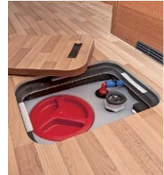
**Auch wenn der LMC keinen Doppelboden hat, ist der Unterflur-Frischwassertank über eine Bodenklappe zugänglich.**
