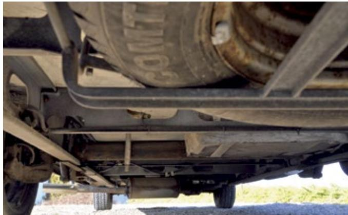
**Der Unterboden ist in Ordnung, wird aber noch mit Unterbodenschutz versiegelt.**
