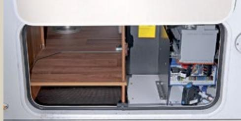
Gut gemacht: Die voluminöse Garage ist sehr groß geraten und lässt sich von beiden Seiten mit Fahrrädern oder anderem Sportgerät beladen. In den Doppelböden integriert Hymer unter anderem die Bordbatterie. Die Auflastung auf 4,5 Tonnen (490 Euro) optimiert die an sich schon üppige Zuladekapazität.
