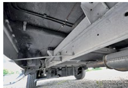
Blick von unten: Rahmen ist rostfrei, die Bodenplatten sind ohne Schäden.
