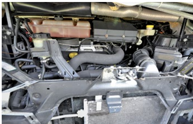
Alles dicht und trocken: Motor und Getriebe sind tadellos in Schuss.
