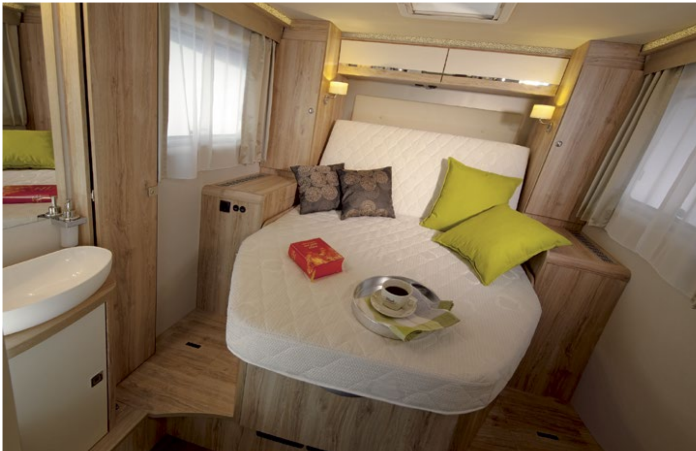
Variable: Das Queensbett über der Heckgarage lässt sich hydraulisch anheben und nach hinten schieben.
