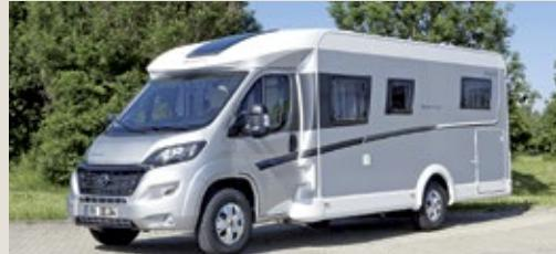
**Basisfahrzeug:** Fiat Ducato mit originalem Tiefrahmenchassis, 2,3-Liter-Turbodiesel mit 109 kW (148 PS), Sechsgang-Schaltgetriebe, Frontantrieb
