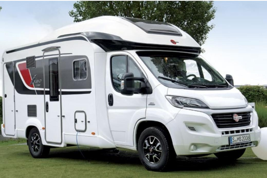
**Schicker Zeitgenosse: Der Ixeo T 640 fällt durch seine voluminöse Dachhutze auf, die das elektrische Hubbett aufnimmt.**
