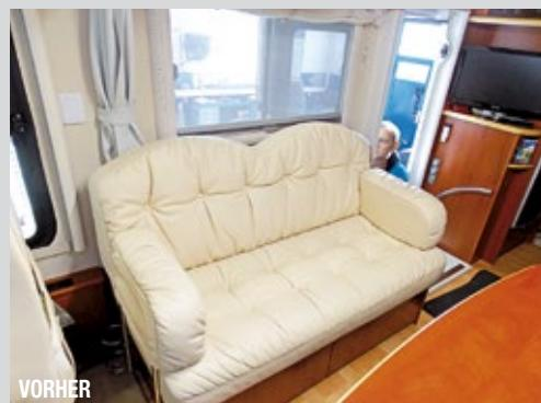
**Ausgangssituation:** Abgesehen von einem Gurtplatz auf der rechten Fahrzeugseite im Grunde die gleiche Situation wie auf Seite 79/79 im Sun Traveller. Nur gilt es, in einem Luxusfahrzeug eine adäquate Lösung für eine seitliche Ledersitzbank zu finden, die zukünftig einen Platz mit Dreipunktgurt bieten soll. Der Charakter der Sitzbank sollte dabei weitestgehend erhalten bleiben.
