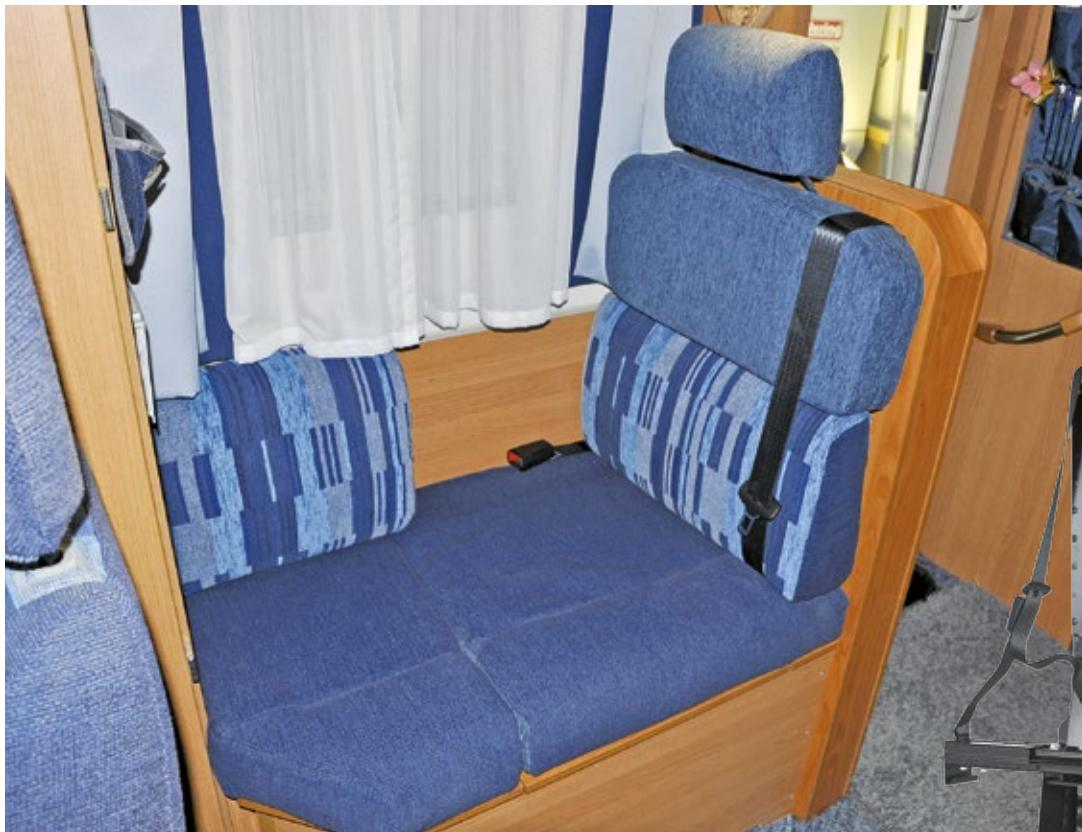
**Fertiger Umbau: Das untere Polster unterm Sicherheitsgurt passt – einmal gedreht – auch in die Lücke unterm Fenster. So wird die Sitzbank wieder zum Sofa für zwei Personen.**
