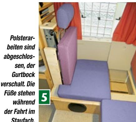
*Polsterarbeiten sind abgeschlossen, der Gurtbock verschalt. Die Füße stehen während der Fahrt im Staufach.*
