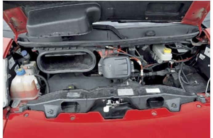
**Eindeutig:** Die Staubschicht beweist, dass alle Dichtungen in Ordnung sind.
