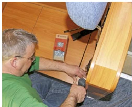
**Wolfgang Hirmke (Bild oben) bohrt am Gurtbock die Gurt-aufnahmen. Im Bild unten schließt Schreinermeister Peter Hofmann die Verschalung des Gurtbocks (rechts im Bild) ab. Die kann sich sehen lassen: Spaltmaß 0,0 Millimeter.**
