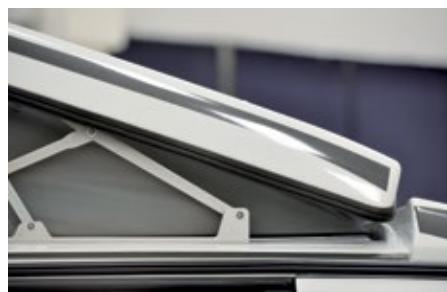
**Neu entwickelt:** Der Mechanismus der Aufstellräder gibt jetzt mehr Stehhöhe her. **Mechanismus alt:** Der Unterschied ist deutlich zu sehen – knapp 20 Zentimeter beträgt er.
