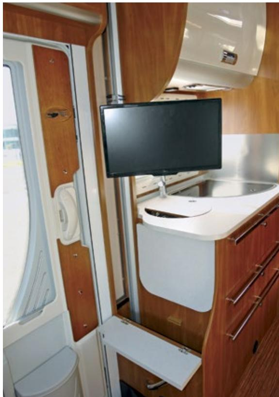
**Einfallsreich:** An der Küche verbaut Laika eine abklappbare Arbeitsplatte und eine TV-Schiene.
