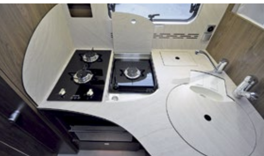
In der Maxi-Flex-Küche ist die dritte Herdflamme unter einer separaten Abdeckung positioniert.
