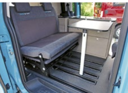
Die Küche ist herausnehmbar. In ihr befinden sich zwei kleine Tanks für Frisch- und Abwasser. Der Tisch wird während der Fahrt verstaut.
