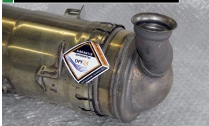
3 DPF nach Reinigung wieder zusammengebaut und verschweißt
