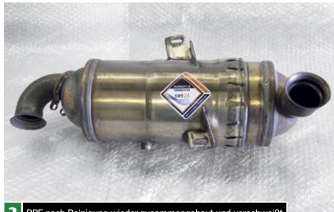
3 DPF nach Reinigung wieder zusammengebaut und verschweißt
