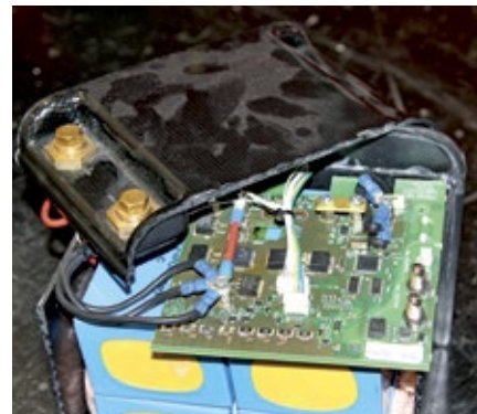
Ein No-Go: Hersteller günstiger LiFePO 4 -Akkus bedienen sich eines BMS von der Stange. Die Kabelklemmungen sind billig gemacht, ebenso die schlecht gesicherten Verschraubungen.
