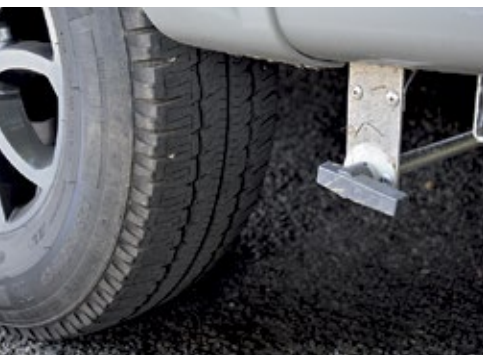
Wenn der Abwasserhahn schon so dicht hinterm linken Hinterrad platziert sein muss, sollte Rapido Schmutzfänger spendieren.
