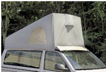
Die Dachmütze am Aufstelldach des Sunvan von Köhler bringt ein dichtes Dach und verringert die Windgeräusche.
