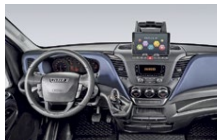
Mit einer speziellen App verbindet sich der Fahrer mit dem Fahrzeugbus. Das Tablet kann abgenommen werden.
