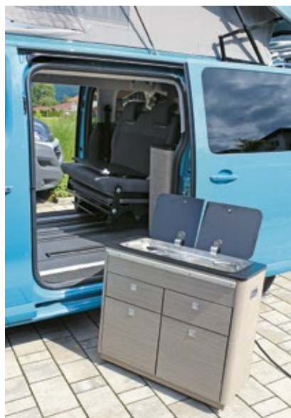
Die Küche ist herausnehmbar. In ihr befinden sich zwei kleine Tanks für Frisch- und Abwasser. Der Tisch wird während der Fahrt verstaut.
