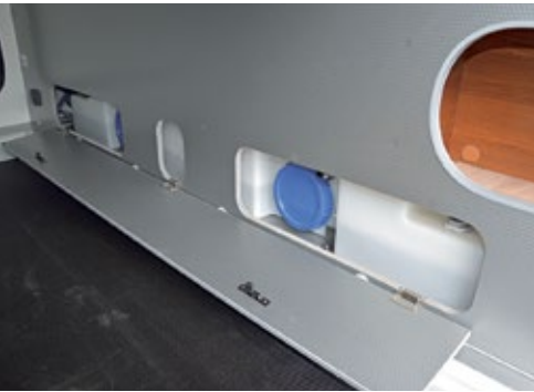
Der Frischwassertank ist über eine Klappe in der zweitürigen Heckgarage gut zu erreichen.
