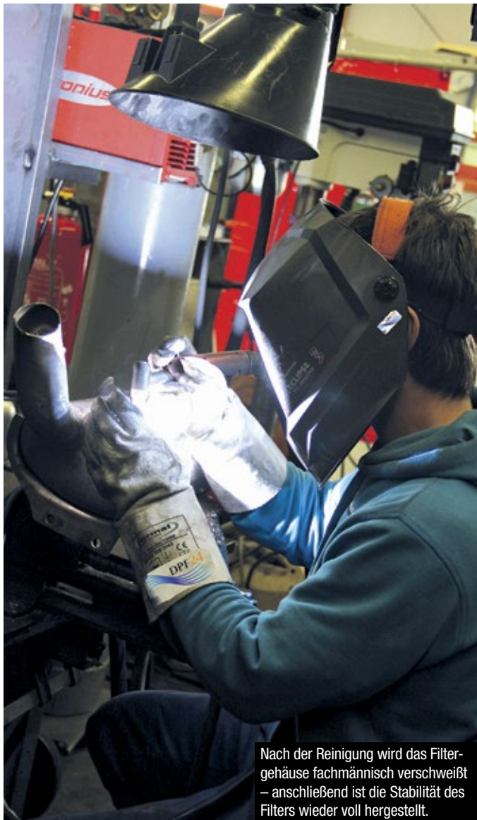
3 DPF nach Reinigung wieder zusammengebaut und verschweißt
