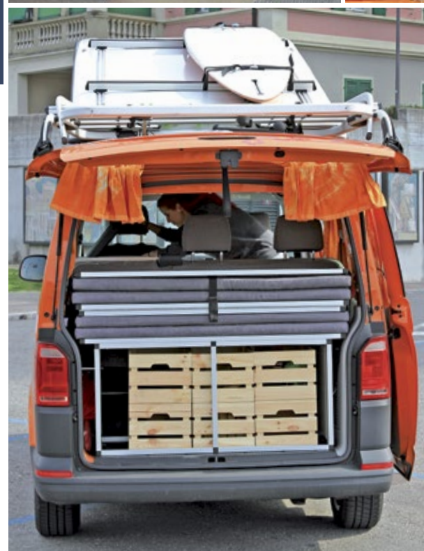
Die Kisten in der herausnehmbaren Bettkonstruktion. Sie stammen von Ikea und werden in der Manufaktur von Terracamper noch stabilisiert. Oben das aufgeklappte Schlafdach von Reimo.
