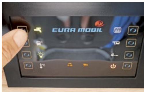
Übersichtlich: Das Panel über der Tür informiert über die Füllstände. Es ist sehr einfach per Touchscreen zu bedienen.
