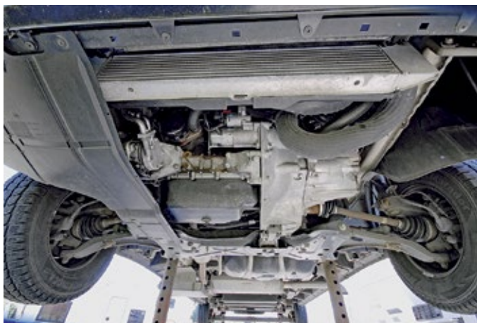
Motor und Getriebe sind trocken und ohne Ölverlust.
