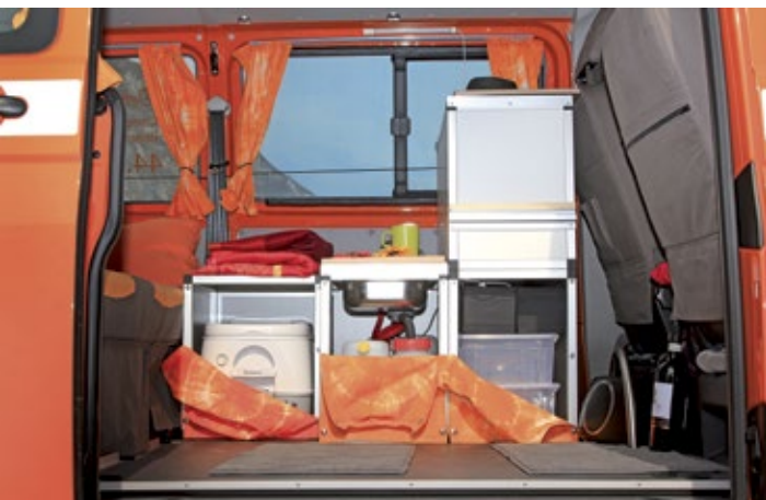
Die herausnehmbare Kühlbox ist sehr praktisch, das Waschbecken von der Form her praxisgerecht. Eine kleine Pumpe treibt den Wasserkreislauf an.
