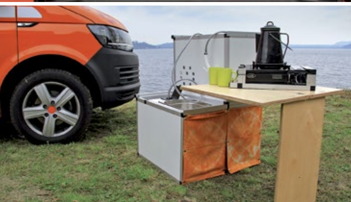
Die Möbelzeile mit Kocher, Waschbecken und rechts oben die Kühlbox. Darunter Wassertanks, Campingtoilette und Staubboxen für Küchenutensilien. Alles lässt sich in wenigen Minuten herausnehmen und auch draußen aufbauen oder im Keller verstauen. Dann wird aus dem Flowcamper ein Alltags-Van.
