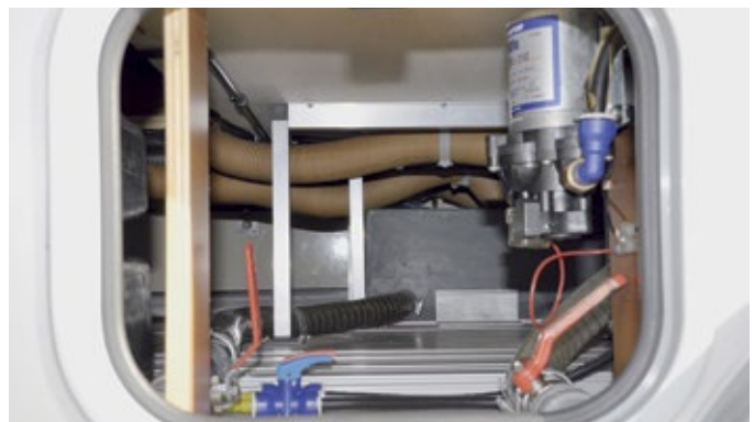
Benutzerfreundlich: Alle Hähne liegen hinter einer einzigen Serviceklappe.
