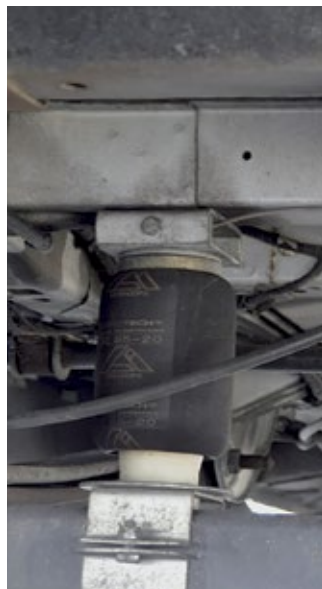
Nützlich: Die Luftfederung von Linnepe erzeugt größere Fahrstabilität.
