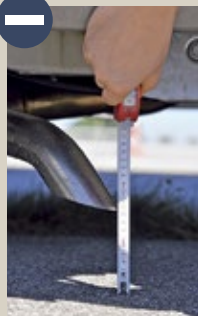
Zu wenig Bodenfreiheit: Der Ducato-Auspuff hängt nur knapp über dem Asphalt.
