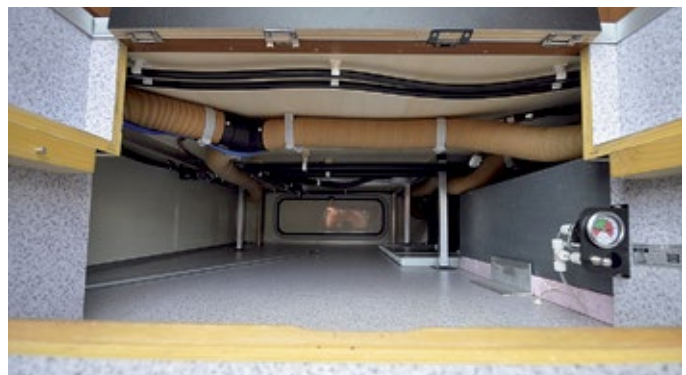
Geräumig: Stauraum und Technikzentrale im Doppelboden des Alkovenmobils.
