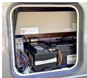
Die Batterien sitzen in einem Fach im beheizten Doppelboden. Die hintere Sitzbank der Rundsitzgruppe schränkt die Heckgarage deutlich ein, wie das Foto zeigt.
