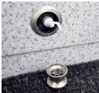
Gescheitert: Reparaturversuch des Vorbesitzers am Pushlock-Schloss.
