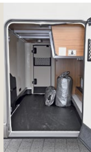
Die Batterien sitzen in einem Fach im beheizten Doppelboden. Die hintere Sitzbank der Rundsitzgruppe schränkt die Heckgarage deutlich ein, wie das Foto zeigt.
