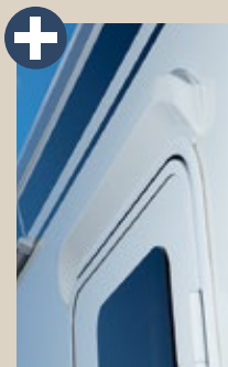
Die Regenrinne verhindert wirksam, dass Regenwasser in die Aufbautür läuft.
