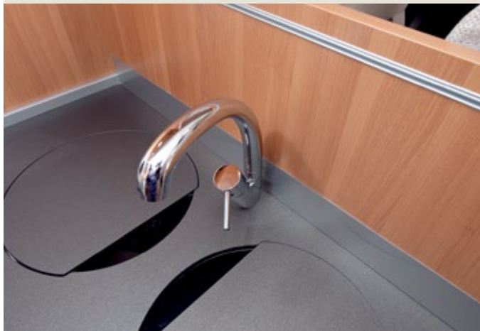
Gemüse putzen und Spaghetti abschrecken gleichzeitig – hierfür wartet die gut ausgestattete Küche des Ecovip 709 mit zwei großen Edelstahlspülen auf. Prima: Endlich hat Laika die Armatur so platziert, dass der Camper beim Abheben des Spülendeckels nicht mehr versehentlich den Wasserhahn öffnet.
