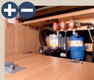
Wasseranlage mit Druckspeicher. Tief montierte Gasabsperrentile.
