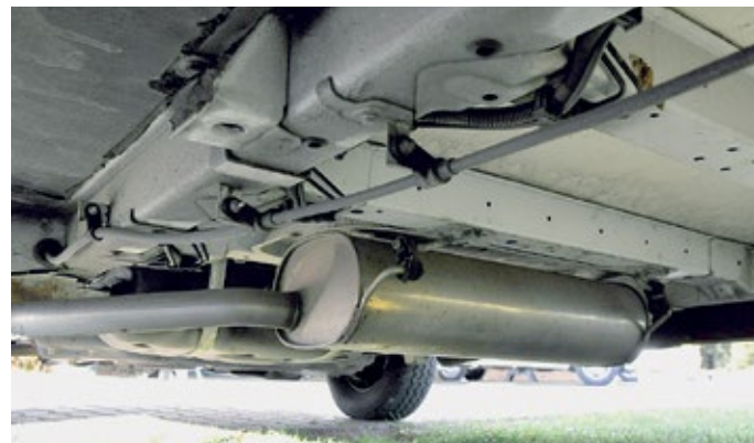
Sauberer Anblick: Der Motor ist trocken, die Füllstände der Flüssigkeiten stimmen, unter dem Boden kein Rost. Einzige die Spur sollte eingestellt werden, die Reifen sind einseitig abgefahren.
