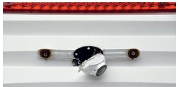
Ärgerlich: Die Rückfahrkamera baumelt nur noch an einem Draht. Hier muss eine neue rein – eine Aufgabe für den Händler Uwe Gante.
