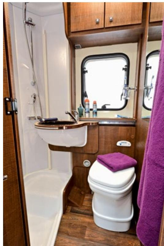
**Gut durchdacht:** Um Platz zu sparen und die Bewegungsfreiheit im Bad zu erhöhen, ist das Waschbecken an einer Metallschiene befestigt, an der es sich mühelos zur Seite schieben lässt. Die Beinfreiheit auf der Toilette ist groß.
