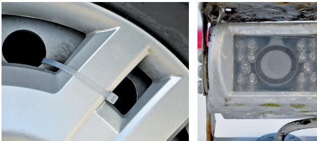
*Gesichert – der Vorbesitzer hat die Radkappen mit Kabelbindern fixiert. Mit der Rückfahrkamera ist nichts mehr zu erkennen, sie ist blind.*
