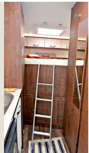
*Clever gemacht: Um den Einstieg ins Heckbett zu erleichtern, lässt sich der Bettkasten manuell per Kurbel in der Höhe verstehen. Das wirkt sich aufs Volumen der Heckgarage aus, die sich darunter befindet.*
