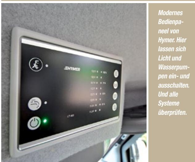
*Modernes Bedienpaneel von Hymer. Hier lassen sich Licht und Wasserpumpen ein- und ausschalten. Und alle Systeme überprüfen.*
