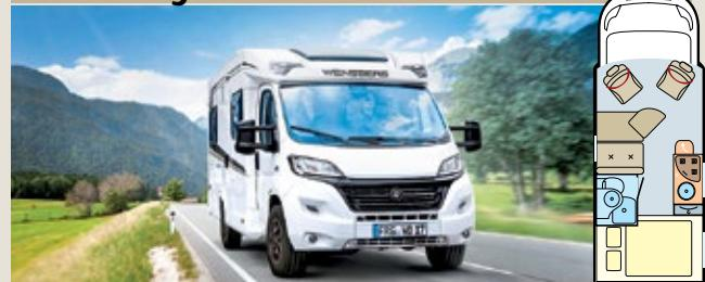
**Basisfahrzeug:** Fiat Ducato mit originalem Tiefrahmenchassis, 2,3-Liter-Turbodiesel mit 96 kW (130 PS), Sechsgang-Schaltgetriebe, Frontantrieb
