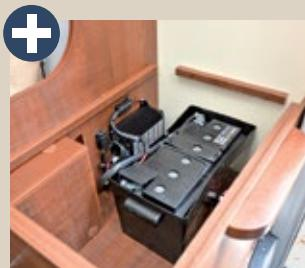
Die Elektrozentrale ist gut zugänglich im Längssitz montiert.
