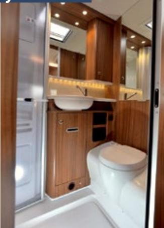
Sehr gut gestaltetes Kompaktbad mit einfach zu bedienender Dusch-Falttür und zusätzlichem Dachlüfter neben der Dachhaube.
