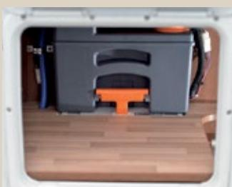
Wie so oft: Bei beiden Probanden ist der Toilettenschacht ungeschützt gegen auslaufendes Wasser.
