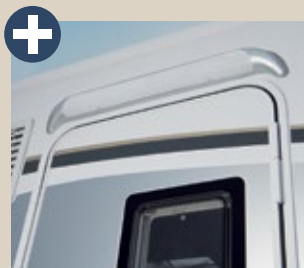
LED-Außenleuchte über der Aufbau- tür mit wirksamer Regenrinne.
