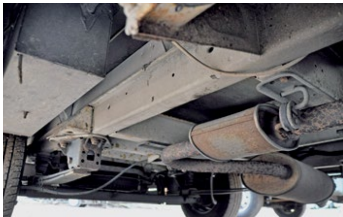
Altersgemäß: Der Unterboden zeigt nur wenig Verschleiß. Träger und Blattfeder sind tadellos, selbst der Flugrost am Auspuff liefert keinen Grund zur Sorge.
