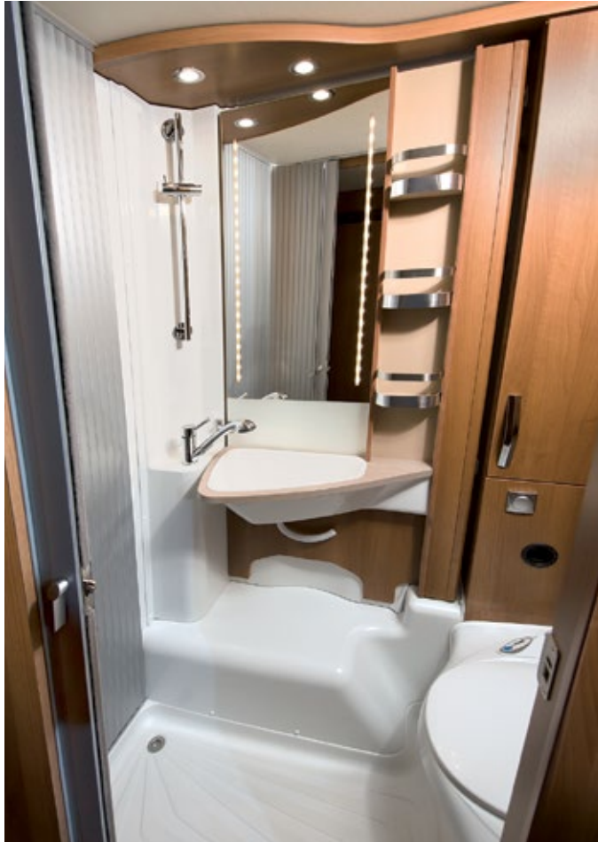
Im Van I 650 MEG setzt Knaus auf eine Banktoilette. Zum Duschen einfach Waschbecken und zugehörige Spiegelwand vors WC schwenken und die Gliedertür zum Gang schließen.
