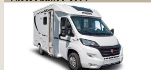
**Basisfahrzeug:** Fiat Ducato 2.3 Mjet mit originalem Tiefrahmenchassis, 2,3-Liter-Turbodiesel mit 96 kW (130 PS), Sechsgang-Schaltgetriebe, Frontantrieb
