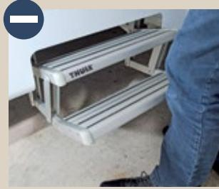
**Die elektrisch ausfahrbare Trittstufe kollidiert mit den Knien des Nutzers.**
