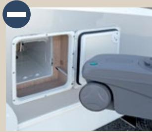
**Der Kassettenenschacht der Toilette ist nicht vollständig abgedichtet.**
