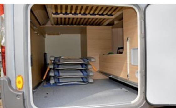
*Im Heck verbirgt sich der 218/137 mal 99/78 mal 91/100 Zentimeter große Stauraum mit zusätzlichem Staufach. In Schieben verschiebbare Zurrösen sichern Ladung und Gepäck.*
