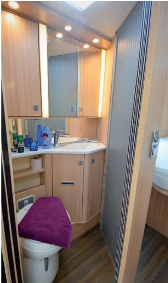
Dank zweier Gliedertüren lässt sich der WC-Raum von vorne und hinten aus betreten – besonders praktisch bei verschlossener Schiebetür zwischen Raumbad und Küche. Wassertank, CEE-Einspeisestecker und Heizungs-Frostsitzventil sind von außen gut erreichbar.
