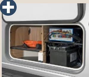
Einfach zugängliches Batteriefach mit Platz für einen zweiten Akku.
