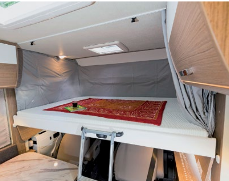
Das manuelle Hubbett ist beim Carado I stets Serie. Unter der Decke rastet es selbsttätig ein. Sein Zentralverschluss und das Feder-tellersystem statt Holzlatenrost unter der Matratze liegen über dem üblichen Einsteigerniveau.
