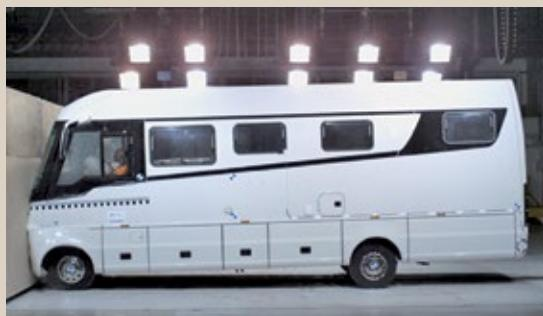
*Entscheidender Moment beim Versuch: Der Flair trifft mit exakt 32 km/h auf die Betonmauer. Die eingeklebte Scheibe springt, bleibt aber in ihrem Rahmen.*
