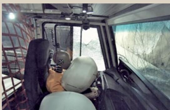
*Wie die Kameras zeigen, halten die in den Sitzen montierten Gurtstraffer die Passagiere exakt in Position. So entfaltet sich die Schutzwirkung der Airbags am besten.*
