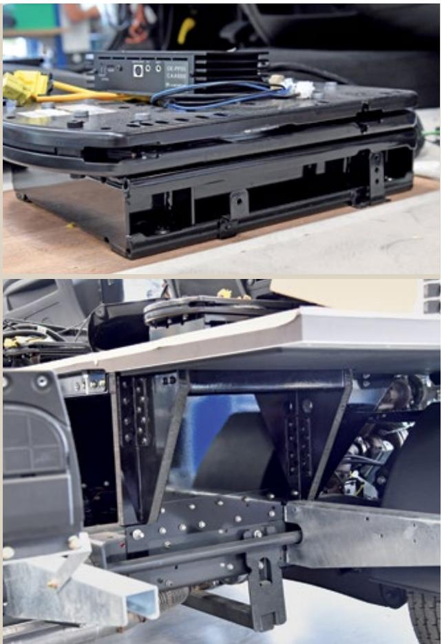
Eine neue Konstruktion: Sandwichplatten sorgen für das Podest, auf dem die Drehkonsole sitzt. Erstaunlich: Die Karosserie des Flair steckt den Aufprall erstaunlich gut weg. Selbst die Klappen funktionieren noch einwandfrei.
