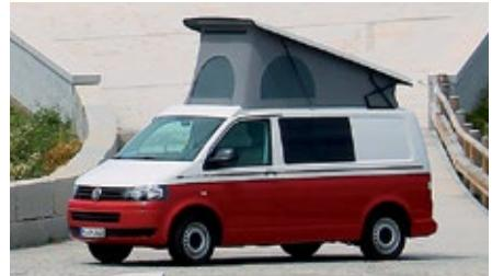
**Die Dachmütze am Aufstelldach des Sunvan von Köhler Wohnmobile bringt ein dichtes Dach und verringert Windgeräusche.**
