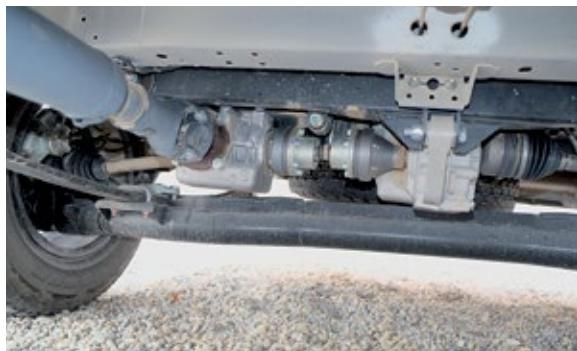
greift – Kraft wird dann zur Hinterachse geleitet. Hier ist es optional möglich, eine mechanische Sperre, die elektronisch zugeschaltet werden kann, einzubauen.
