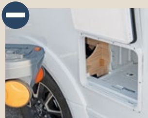
Der Kassettenschacht der Toilette ist nicht vollständig abgedichtet.
